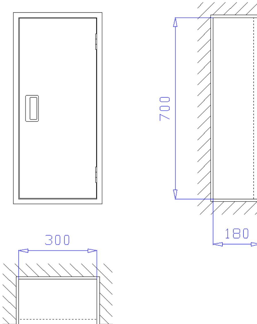
**Unterputzschrank** 300 x 700 x 180 mm, für Nische 320 x 720 x 190 mm (Breite x Höhe x Tiefe) zur Aufnahme eines 6kg Handfeuerlöschers. Schrank aus 1 mm verzinktem Stahlblech gekantet und verschweißt, mit Putzleiste aus Winkeleisen 20x20x3 mm, frontseitige Stöße verschweißt und verschliffen. Belüftung über Türspalt. Montagebohrungen in der Rückwand.
