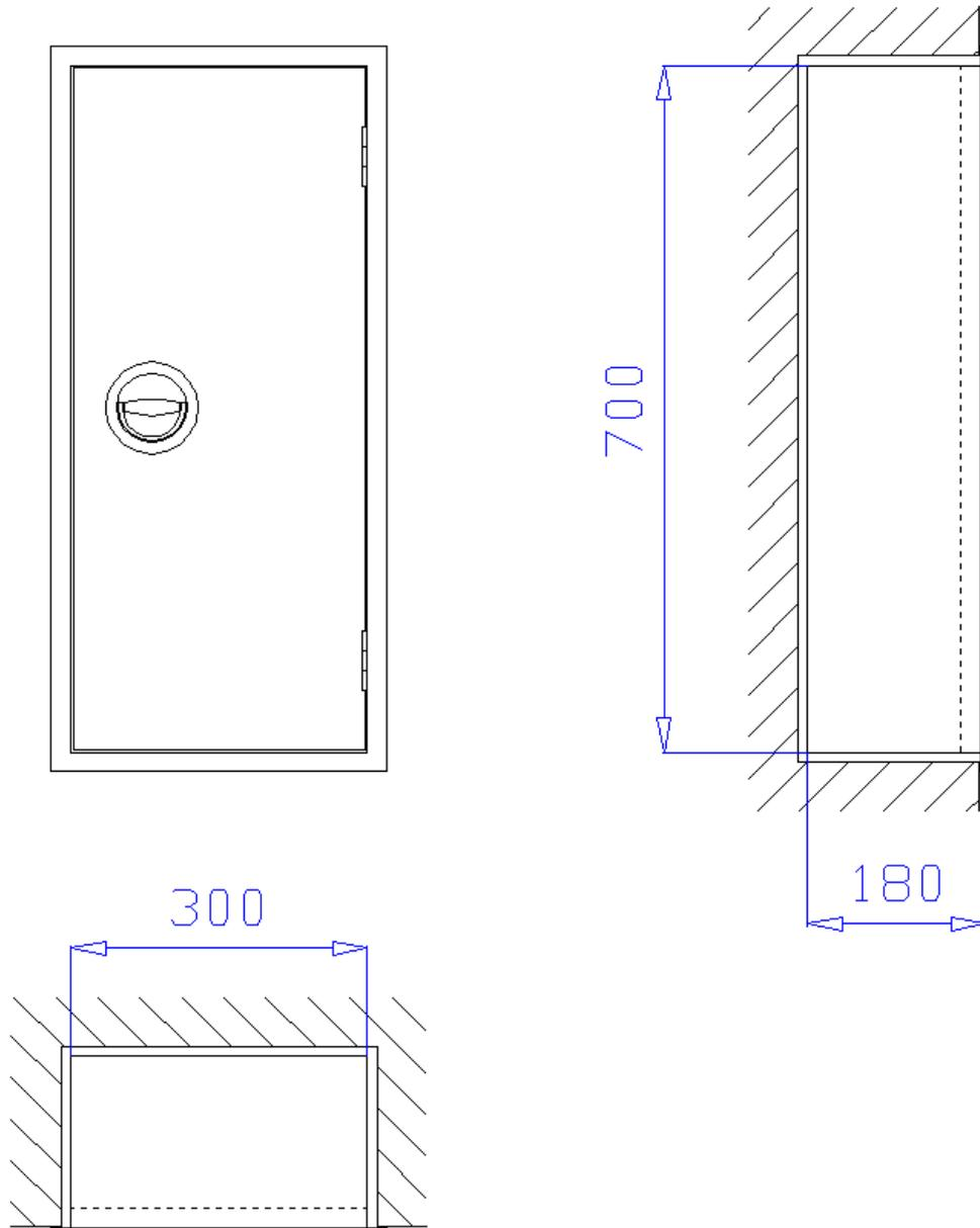
**Unterputzschrank** 300 x 700 x 180 mm, für Nische 320 x 720 x 190 mm (Breite x Höhe x Tiefe) zur Aufnahme eines 6kg Handfeuerlöschers. Schrank aus 1 mm verzinktem Stahlblech gekantet und verschweißt, mit Putzleiste aus Winkleisen 20x20x3 mm, frontseitige Stöße verschweißt und verschliffen. Belüftung über Türspalt. Montagebohrungen in der Rückwand.
