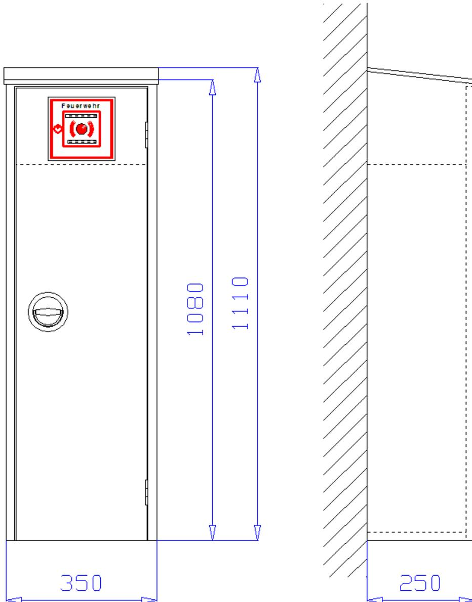
**Aufputzschrank** 350 x 1080/1110 x 250 mm (Breite x Höhe x Tiefe) mit schrägem Dach, an drei Seiten überstehend, zur Aufnahme eines 6kg CO<sub>2</sub> Handfeuerlöschers. Schrank aus 1 mm verzinktem Stahlblech gekantet und verschweißt. Über dem Feuerlöscherfach abgeschottetes Fach zur Aufnahme eines Handfeuermelders mit einer verstellbaren Konsole zur Montage des Handfeuermelders und entsprechendem Ausschnitt (140 x 140 mm) in der Tür. Belüftung über Türspalt. Montagebohrungen in der Rückwand.
