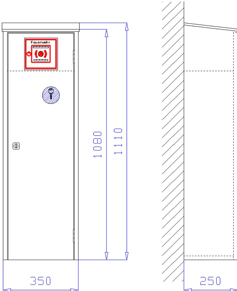
**Aufputzschrank 350 x 1080/1110 x 250 mm** (Breite x Höhe x Tiefe) mit schrägem Dach, an drei Seiten überstehend, zur Aufnahme eines 6kg CO<sub>2</sub> Handfeuerlöschers. Schrank aus 1 mm verzinktem Stahlblech gekantet und verschweißt. Über dem Feuerlöscherfach abgeschottetes Fach zur Aufnahme eines Handfeuermelders mit einer verstellbaren Konsole zur Montage des Handfeuermelders und entsprechendem Ausschnitt (140 x 140 mm) in der Tür. Belüftung über Türspalt. Montagebohrungen in der Rückwand.
