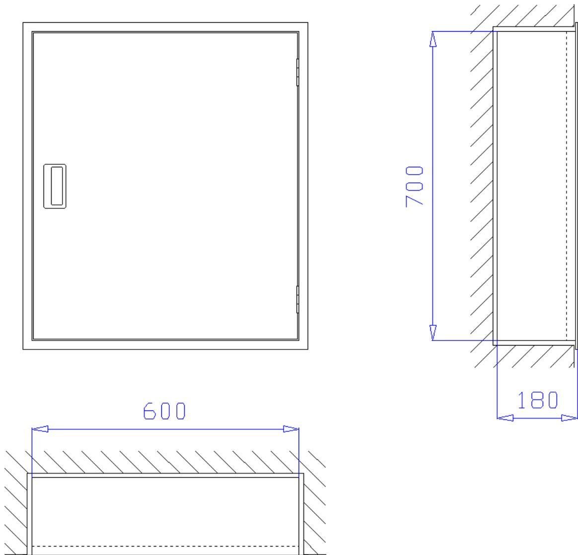
**Unterputzschrank** 600 x 700 x 180 mm, für Nische 620 x 720 x 190 mm (Breite x Höhe x Tiefe) zur Aufnahme von zwei 6kg Handfeuerlöschern. Schrank aus 1 mm verzinktem Stahlblech gekantet und verschweißt, mit Putzleiste aus Winkeleisen 20x20x3 mm, frontseitige Stöße verschweißt und verschliffen. Belüftung über Türspalt. Montagebohrungen in der Rückwand.
