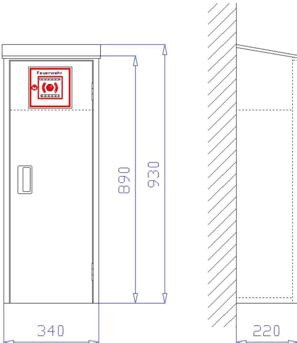
**Aufputzschrank 340 x 890/930 x 220 mm** (Breite x Höhe x Tiefe) mit schrägem Dach, an drei Seiten überstehend, zur Aufnahme eines 6kg oder 12kg Handfeuerlöschers. Schrank aus 1 mm verzinktem Stahlblech gekantet und verschweißt. Über dem Feuerlöscherfach abgeschottetes Fach zur Aufnahme eines Handfeuermelders mit einer verstellbaren Konsole zur Montage des Handfeuermelders und entsprechendem Ausschnitt (140 x 140 mm) in der Tür. Belüftung über Türspalt. Montagebohrungen in der Rückwand.
