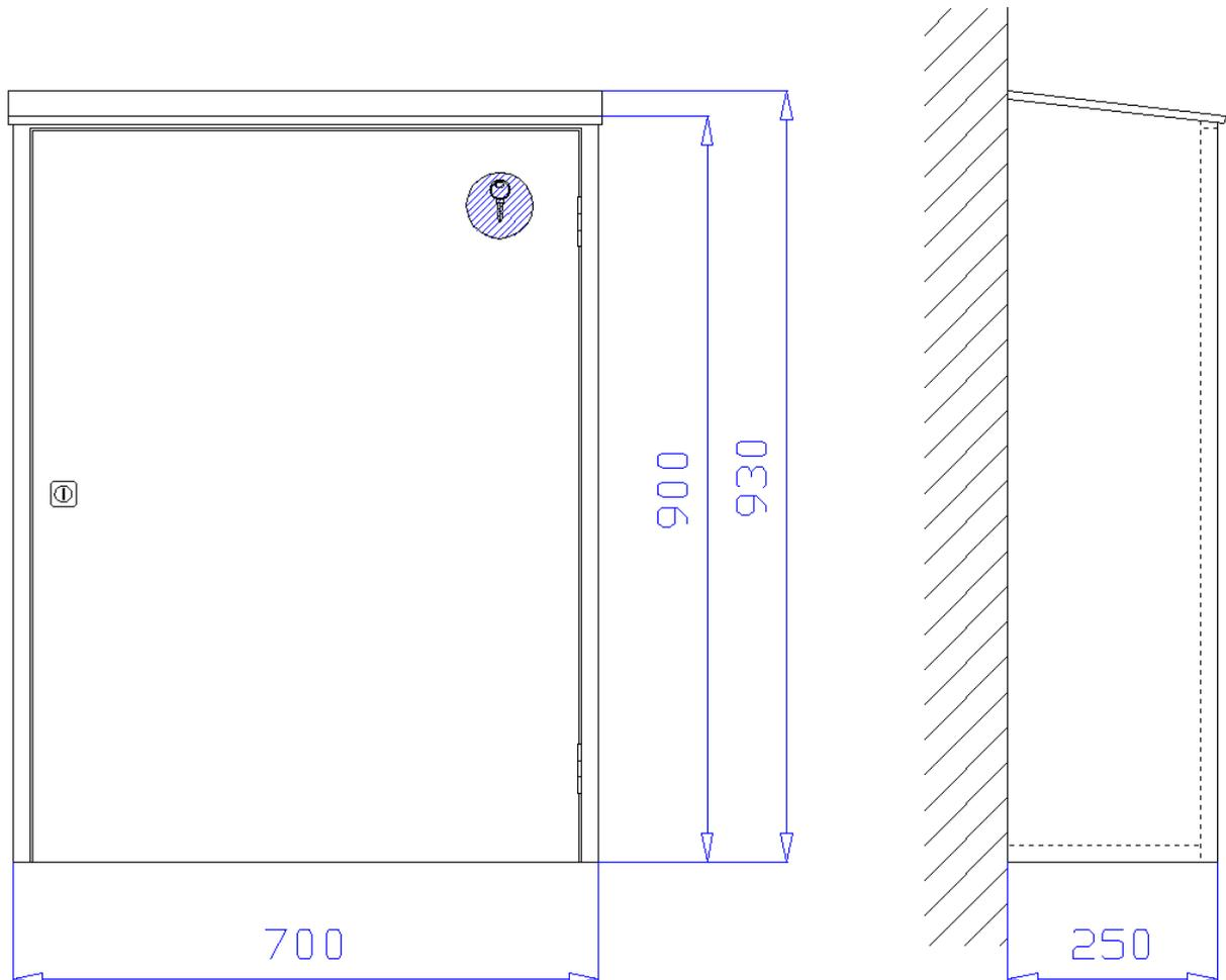
**Aufputzschrank** 700 x 900/930 x 250 mm (Breite x Höhe x Tiefe) mit schrägem Dach, an drei Seiten überstehend, zur Aufnahme von zwei 6kg CO<sup>2</sup> Handfeuerlöschern. Schrank aus 1 mm verzinktem Stahlblech gekantet und verschweißt, Belüftung über Türspalt. Montagebohrungen in der Rückwand.
