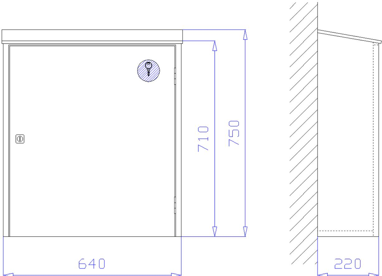
**Aufputzschrank** 640 x 710/750 x 220 mm (Breite x Höhe x Tiefe) mit schrägem Dach, an drei Seiten überstehend, zur Aufnahme von zwei 6kg oder 12kg Handfeuerlöschern. Schrank aus 1 mm verzinktem Stahlblech gekantet und verschweißt, Belüftung über Türspalt. Montagebohrungen in der Rückwand.
