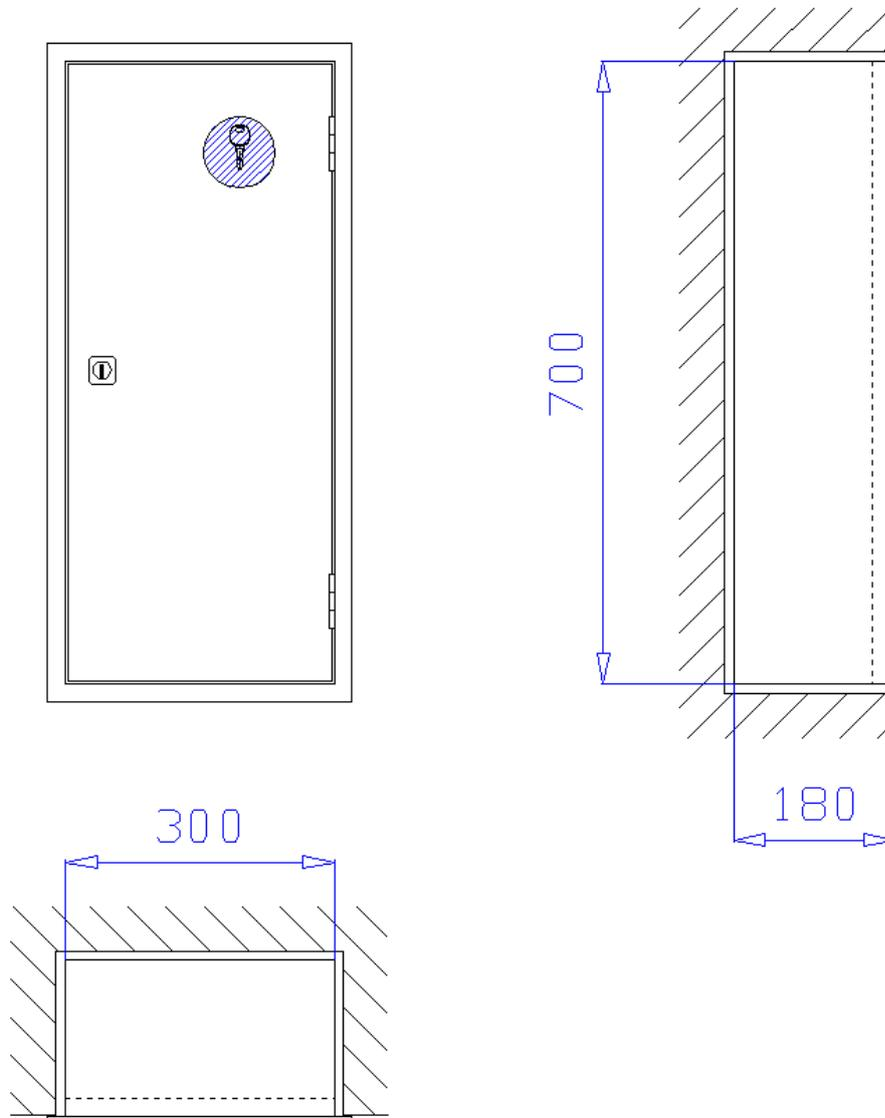
**Unterputzschrank** 300 x 700 x 180 mm, für Nische 320 x 720 x 190 mm (Breite x Höhe x Tiefe) zur Aufnahme eines 6kg Handfeuerlöscher. Schrank aus 1 mm verzinktem Stahlblech gekantet und verschweißt, mit Putzleiste aus Winkeleisen 20x20x3mm, frontseitige Stöße verschweißt und verschliffen. Belüftung über Türspalt. Montagebohrungen in der Rückwand.
