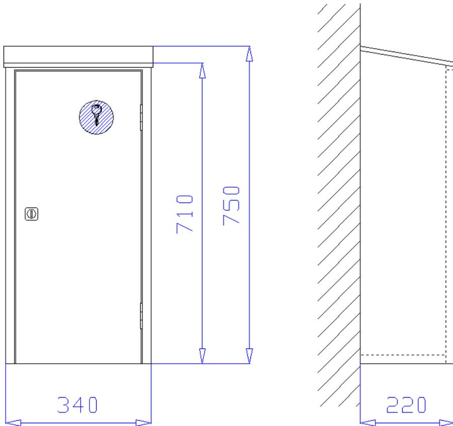
**Aufputzschrank** 340 x 710/750 x 220 mm (Breite x Höhe x Tiefe) mit schrägem Dach, an drei Seiten überstehend, zur Aufnahme eines 6kg oder 12kg Handfeuerlöschers. Schrank aus 1 mm verzinktem Stahlblech gekantet und verschweißt, Belüftung über Türspalt. Montagebohrungen in der Rückwand. Grau RAL 7035 pulverbeschichtet, gegen Mehrpreis endlackiert - rot RAL 3001 pulverbeschichtet -.
