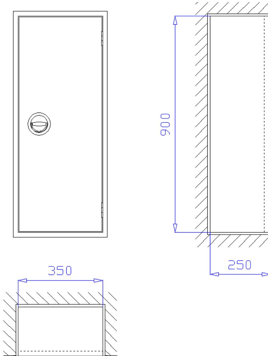
**Unterputzschrank** 350 x 900 x 250 mm, für Nische 370 x 920 x 260 mm (Breite x Höhe x Tiefe) zur Aufnahme eines 6kg CO<sub>2</sub> Handfeuerlöschers. Schrank aus 1 mm verzinktem Stahlblech gekantet und verschweißt, mit Putzleiste aus Winkleisen 20x20x3 mm, frontseitige Stöße verschweißt und verschliffen. Belüftung über Türspalt. Montagebohrungen in der Rückwand.
