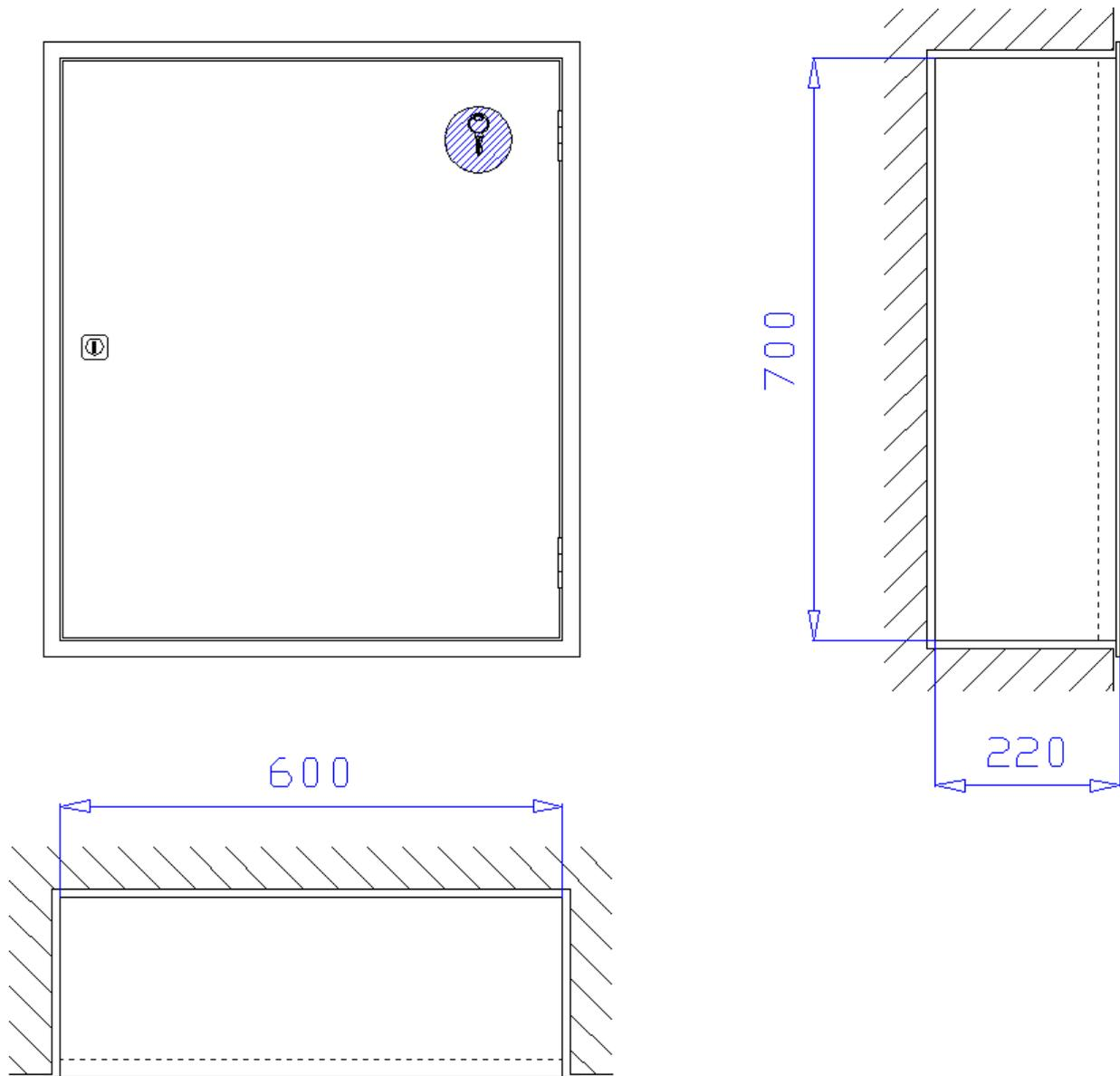
**Unterputzschrank** 600 x 700 x 220 mm, für Nische 620 x 720 x 230 mm (Breite x Höhe x Tiefe) zur Aufnahme von zwei 12kg Handfeuerlöschern. Schrank aus 1 mm verzinktem Stahlblech gekantet und verschweißt, mit Putzleiste aus Winkeleisen 20x20x3 mm, frontseitige Stöße verschweißt und verschliffen. Belüftung über Türspalt. Montagebohrungen in der Rückwand.
