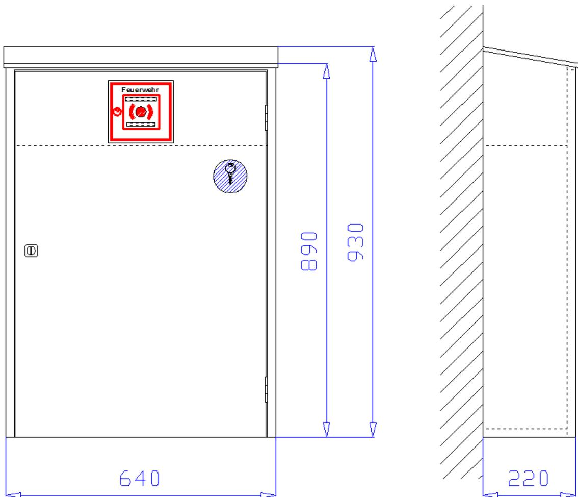
**Aufputzschrank** 640 x 890/930 x 220 mm (Breite x Höhe x Tiefe) mit schrägem Dach, an drei Seiten überstehend, zur Aufnahme von zwei 6kg oder 12kg Handfeuerlöschern. Schrank aus 1 mm verzinktem Stahlblech gekantet und verschweißt. Über dem Feuerlöscherfach abgeschottetes Fach zur Aufnahme eines Handfeuermelders mit einer verstellbaren Konsole zur Montage des Handfeuermelders und entsprechendem Ausschnitt (140 x 140 mm) in der Tür. Belüftung über Türspalt. Montagebohrungen in der Rückwand.
