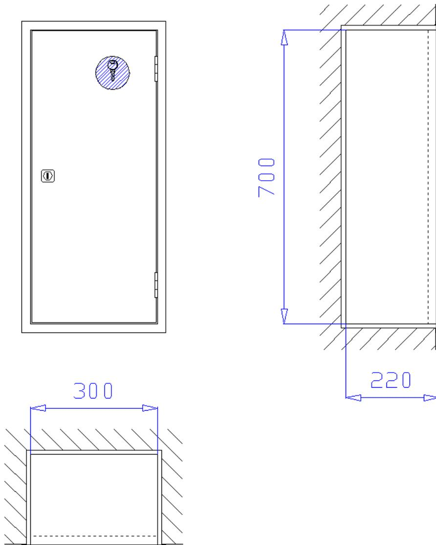
**Unterputzschrank** 300 x 700 x 220 mm, für Nische 320 x 720 x 230 mm (Breite x Höhe x Tiefe) zur Aufnahme eines 12kg Handfeuerlöschers. Schrank aus 1 mm verzinktem Stahlblech gekantet und verschweißt, mit Putzleiste aus Winkeleisen 20x20x3 mm, frontseitige Stöße verschweißt und verschliffen. Belüftung über Türspalt. Montagebohrungen in der Rückwand.
