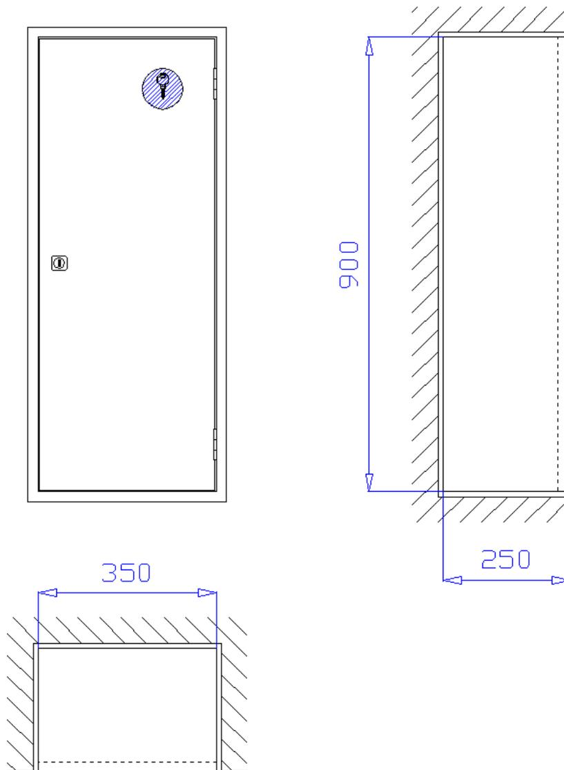
**Unterputzschrank** 350 x 900 x 250 mm, für Nische 370 x 920 x 260 mm (Breite x Höhe x Tiefe) zur Aufnahme eines 6kg CO<sub>2</sub> Handfeuerlöschers. Schrank aus 1 mm verzinktem Stahlblech gekantet und verschweißt, mit Putzleiste aus Winkeleisen 20x20x3mm, frontseitige Stöße verschweißt und verschliffen. Belüftung über Türspalt. Montagebohrungen in der Rückwand.
