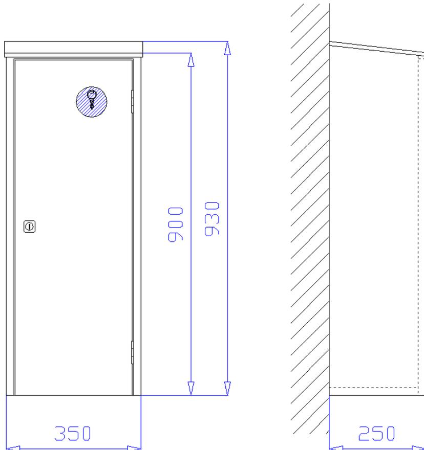
**Aufputzschrank** 350 x 900/930 x 250 mm (Breite x Höhe x Tiefe) mit schrägem Dach, an drei Seiten überstehend, zur Aufnahme eines 6kg CO<sub>2</sub> Handfeuerlöschers. Schrank aus 1 mm verzinktem Stahlblech gekantet und verschweißt, Belüftung über Türspalt. Montagebohrungen in der Rückwand.
