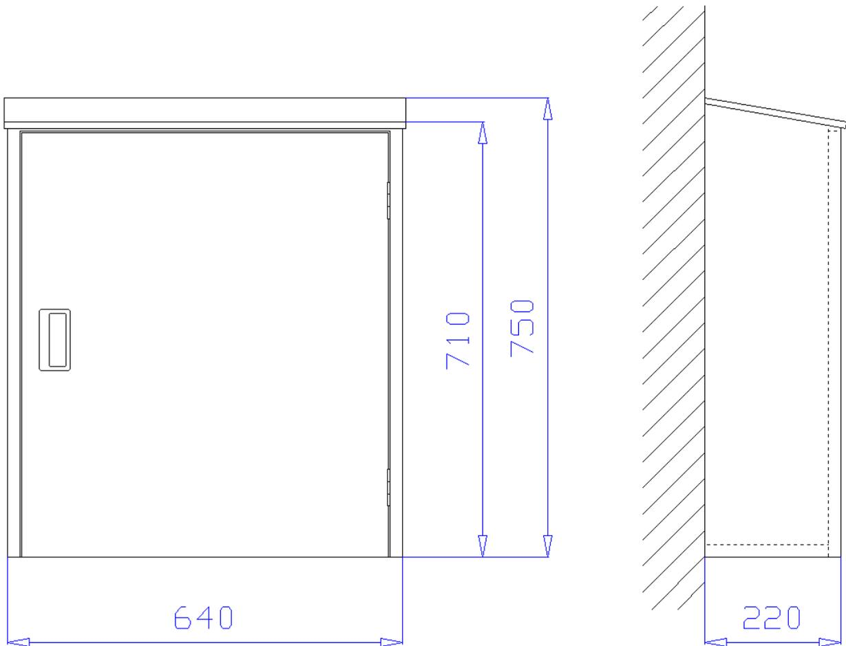
**Aufputzschrank** 640 x 710/750 x 220 mm (Breite x Höhe x Tiefe) mit schrägem Dach, an drei Seiten überstehend, zur Aufnahme von zwei 6kg oder 12kg Handfeuerlöschern. Schrank aus 1 mm verzinktem Stahlblech gekantet und verschweißt, Belüftung über Türspalt. Montagebohrungen in der Rückwand.
