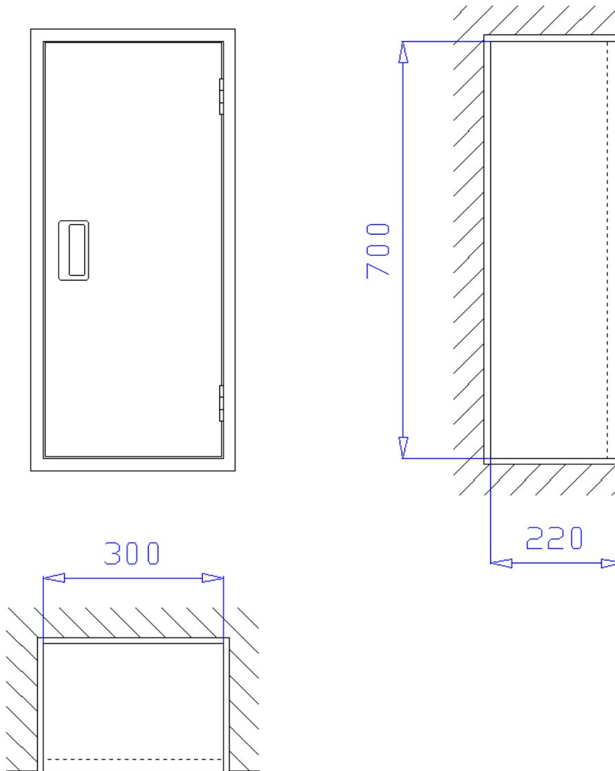
**Unterputzschrank** 300 x 700 x 220 mm, für Nische 320 x 720 x 230 mm (Breite x Höhe x Tiefe) zur Aufnahme eines 12kg Handfeuerlöschers. Schrank aus 1 mm verzinktem Stahlblech gekantet und verschweißt, mit Putzleiste aus Winkeleisen 20x20x3 mm, frontseitige Stöße verschweißt und verschliffen. Belüftung über Türspalt. Montagebohrungen in der Rückwand.
