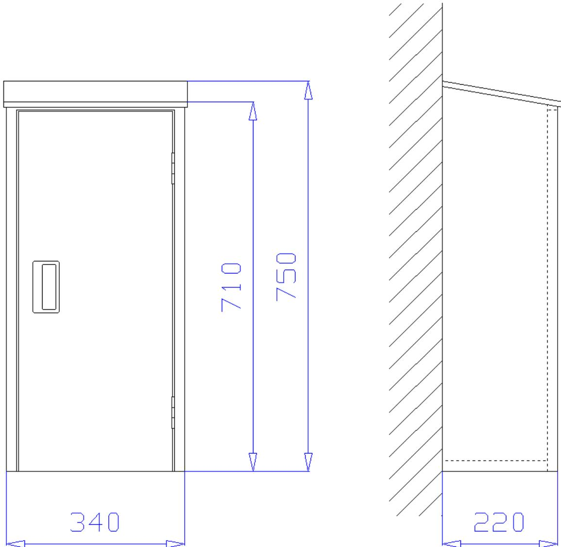
**Aufputzschrank** 340 x 710/750 x 220 mm (Breite x Höhe x Tiefe) mit schrägem Dach, an drei Seiten überstehend, zur Aufnahme eines 6kg oder 12kg Handfeuerlöschers. Schrank aus 1 mm verzinktem Stahlblech gekantet und verschweißt, Belüftung über Türspalt. Montagebohrungen in der Rückwand.
