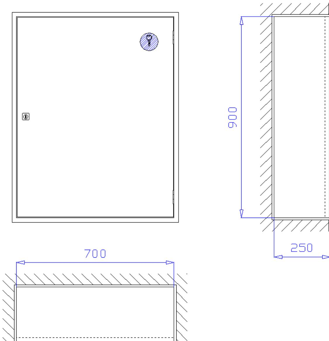
**Unterputzschrank** 700 x 900 x 250 mm, für Nische 720 x 920 x 260 mm (Breite x Höhe x Tiefe) zur Aufnahme von zwei 6kg CO<sup>2</sup> Handfeuerlöschern. Schrank aus 1 mm verzinktem Stahlblech gekantet und verschweißt, mit Putzleiste aus Winkeleisen 20x20x3 mm, frontseitige Stöße verschweißt und verschliffen. Belüftung über Türspalt. Montagebohrungen in der Rückwand.
