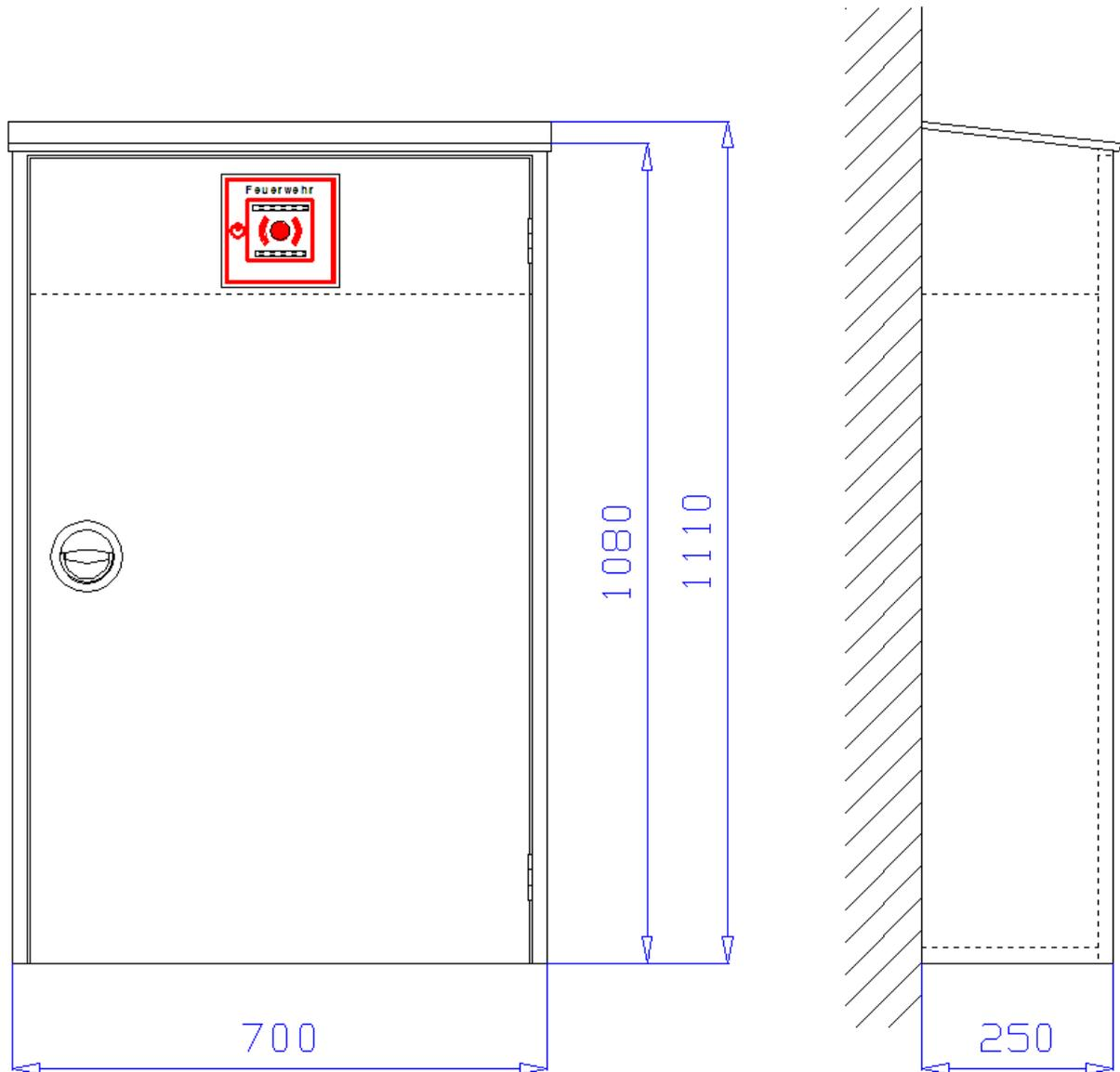
**Aufputzschrank** 700 x 1080/1110 x 250 mm (Breite x Höhe x Tiefe) mit schrägem Dach, an drei Seiten überstehend, zur Aufnahme von zwei 6kg CO<sub>2</sub> Handfeuerlöschern. Schrank aus 1 mm verzinktem Stahlblech gekantet und verschweißt. Über dem Feuerlöscherfach abgeschottetes Fach zur Aufnahme eines Handfeuermelders mit einer verstellbaren Konsole zur Montage des Handfeuermelders und entsprechendem Ausschnitt (140 x 140 mm) in der Tür. Montagebohrungen in der Rückwand.
