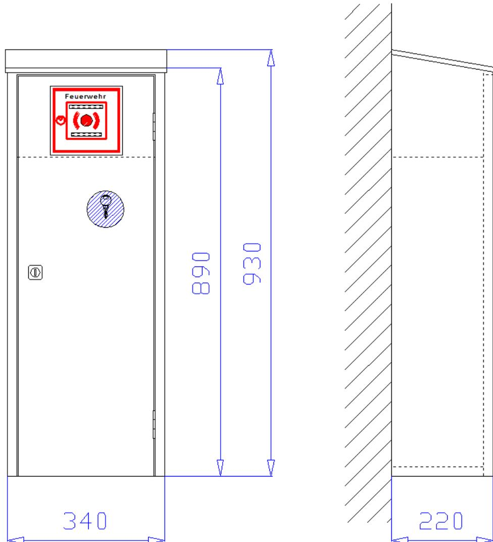
**Aufputzschrank** 340 x 890/930 x 220 mm (Breite x Höhe x Tiefe) mit schrägem Dach, an drei Seiten überstehend, zur Aufnahme eines 6kg oder 12kg Handfeuerlöschers. Schrank aus 1 mm verzinktem Stahlblech gekantet und verschweißt. Über dem Feuerlöscherfach abgeschottetes Fach zur Aufnahme eines Handfeuermelders mit einer verstellbaren Konsole zur Montage des Handfeuermelders und entsprechendem Ausschnitt (140 x 140 mm) in der Tür. Belüftung über Türspalt. Montagebohrungen in der Rückwand.
