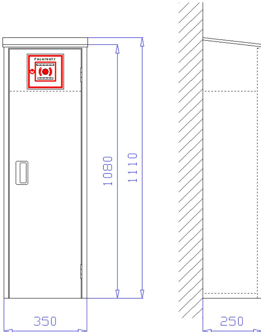
**Aufputzschrank 350 x 1080/1110 x 250 mm** (Breite x Höhe x Tiefe) mit schrägem Dach, an drei Seiten überstehend, zur Aufnahme eines 6kg CO<sub>2</sub> Handfeuerlöschers. Schrank aus 1 mm verzinktem Stahlblech gekantet und verschweißt. Über dem Feuerlöscherfach abgeschottetes Fach zur Aufnahme eines Handfeuermelders mit einer verstellbaren Konsole zur Montage des Handfeuermelders und entsprechendem Ausschnitt (140 x 140 mm) in der Tür. Montagebohrungen in der Rückwand.
