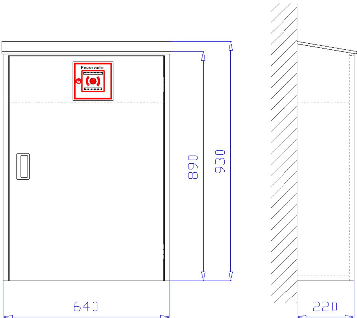
**Aufputzschrank** 640 x 890/930 x 220 mm (Breite x Höhe x Tiefe) mit schrägem Dach, an drei Seiten überstehend, zur Aufnahme von zwei 6kg oder 12kg Handfeuerlöschern. Schrank aus 1 mm verzinktem Stahlblech gekantet und verschweißt. Über dem Feuerlöscherfach abgeschottetes Fach zur Aufnahme eines Handfeuermelders mit einer verstellbaren Konsole zur Montage des Handfeuermelders und entsprechendem Ausschnitt (140 x 140 mm) in der Tür. Belüftung über Türspalt. Montagebohrungen in der Rückwand.
