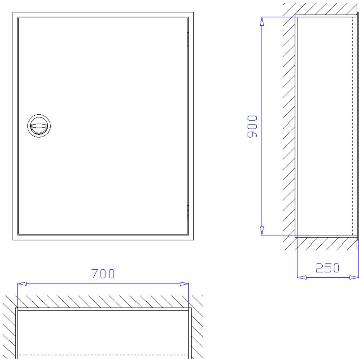
**Unterputzschrank** 700 x 900 x 250 mm, für Nische 720 x 920 x 260 mm (Breite x Höhe x Tiefe) zur Aufnahme von zwei 6kg CO<sub>2</sub> Handfeuerlöschern. Schrank aus 1 mm verzinktem Stahlblech gekantet und verschweißt, mit Putzleiste aus Winkeleisen 20x20x3 mm, frontseitige Stöße verschweißt und verschliffen. Belüftung über Türspalt. Montagebohrungen in der Rückwand.
