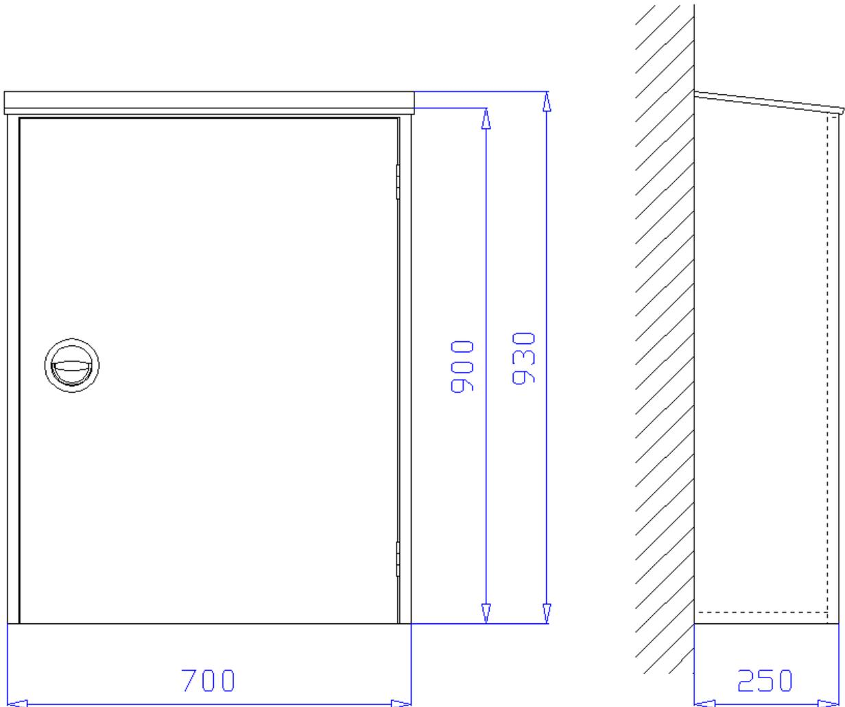
**Aufputzschrank** 700 x 900/930 x 250 mm (Breite x Höhe x Tiefe) mit schrägem Dach, an drei Seiten überstehend, zur Aufnahme von zwei 6kg CO<sub>2</sub> Handfeuerlöschern. Schrank aus 1 mm verzinktem Stahlblech gekantet und verschweißt, Belüftung über Türspalt. Montagebohrungen in der Rückwand.
