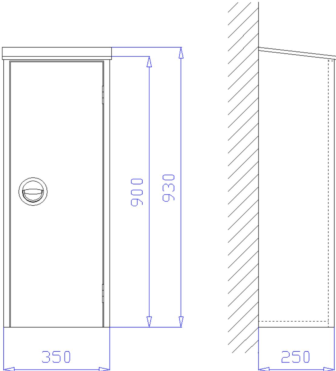
**Aufputzschrank** 350 x 900/935 x 250 mm (Breite x Höhe x Tiefe) mit schrägem Dach, an drei Seiten überstehend, zur Aufnahme eines 6kg CO<sup>2</sup> Handfeuerlöschers. Schrank aus 1 mm verzinktem Stahlblech gekantet und verschweißt, Belüftung über Türspalt. Montagebohrungen in der Rückwand. Grau RAL 7035 pulverbeschichtet, gegen Mehrpreis endlackiert - rot RAL 3001 pulverbeschichtet -.
