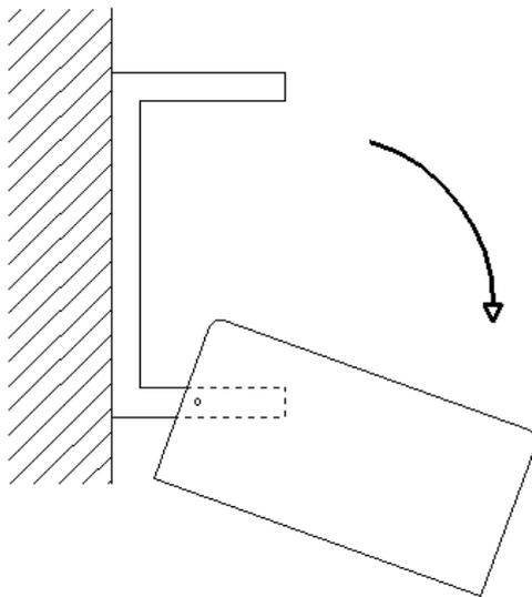
**Behälter** aus verzinktem Stahlblech 315 x 315 x 150 mm (Breite x Höhe x Tiefe) gekantet und verschweißt, der nach vorn herunterklappt, wobei die Löschdecke frei liegen bleibt und herausgenommen werden kann, Klappe mit Kunststoffgriffmuschel.
