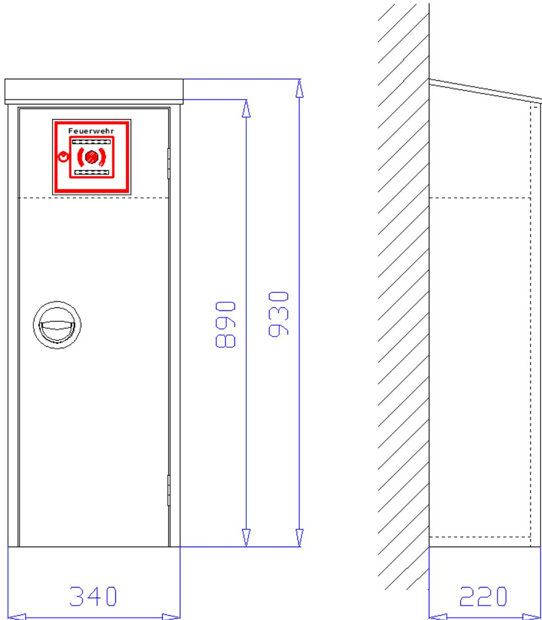
**Aufputzschrank** 340 x 890/930 x 220 mm (Breite x Höhe x Tiefe) mit schrägem Dach, an drei Seiten überstehend, zur Aufnahme eines 6kg oder 12kg Handfeuerlöschers. Schrank aus 1 mm verzinktem Stahlblech gekantet und verschweißt. Über dem Feuerlöscherschfach abgeschottetes Fach zur Aufnahme eines Handfeuermelders mit einer verstellbaren Konsole zur Montage des Handfeuermelders und entsprechendem Ausschnitt (140 x 140 mm) in der Tür. Belüftung über Türspalt. Montagebohrungen in der Rückwand.
