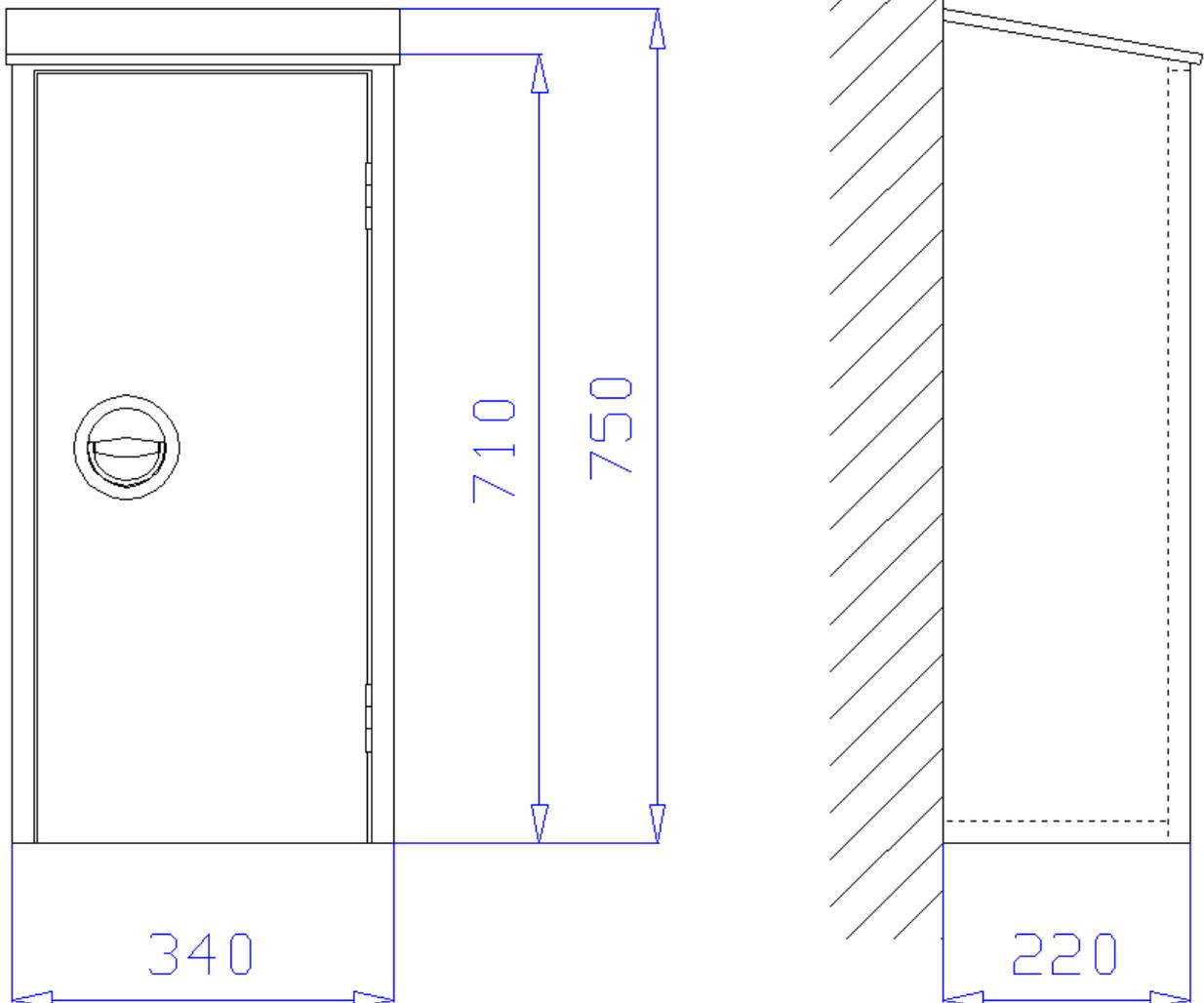
**Aufputzschrank** 340 x 710/750 x 220 mm (Breite x Höhe x Tiefe) mit schrägem Dach, an drei Seiten überstehend, zur Aufnahme eines 6kg oder 12kg Handfeuerlöschers. Schrank aus 1 mm verzinktem Stahlblech gekantet und verschweißt, Belüftung über Türspalt. Montagebohrungen in der Rückwand.
