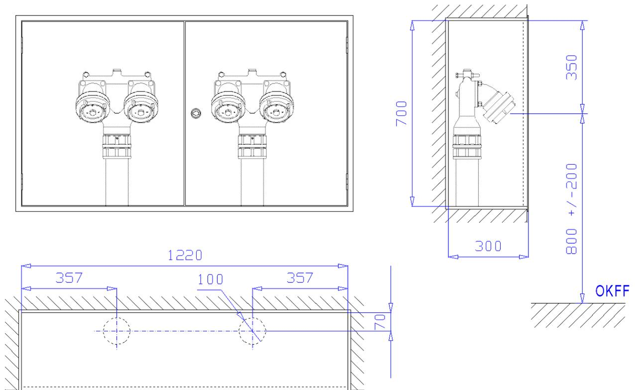
**Unterputzschrank** Bauart B, 1220 x 700 x 300 mm, für Nische 1240 x 720 x 310 mm (Breite x Höhe x Tiefe) nach DIN 14461-2 zur Aufnahme von zwei Löschwasser-Einspeisearmaturen nach DIN 14461-4. Aus 1 mm verzinktem Stahlblech gekantet und verschweißt, mit Putzleiste aus Winkeleisen 25x25x3 mm, frontseitige Stöße verschweißt und verschliffen. Belüftung über Türspalt. Vier Montagebohrungen in der Rückwand. Zwei Wasseranschlussöffnungen  $\varnothing$  100 mm im Boden.
