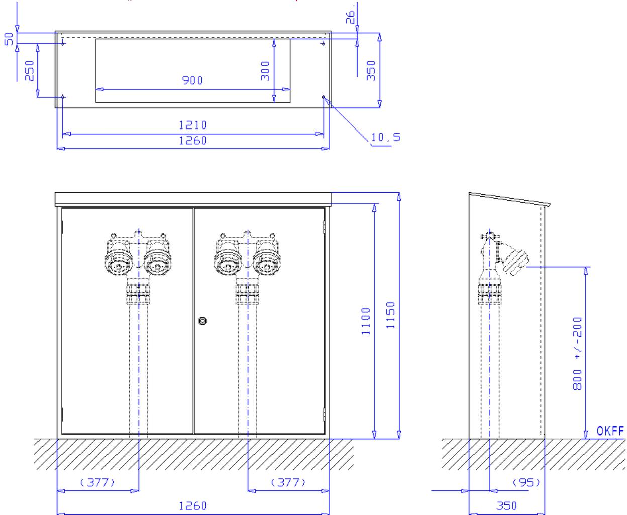
**Schrank zur freien Aufstellung**, 1260 x 1100/1150 x 350 mm (Breite x Höhe x Tiefe) nach DIN 14461-2 zur Aufnahme von zwei Löschwasser-Einspeisearmaturen nach DIN 14461-4. Aus 1 mm verzinktem Stahlblech gekantet und verschweißt, frontseitige Stöße verschweißt und verschliffen. Noch vorne abfallendes Wetterschutzdach an drei Seiten überstehen. Belüftung über Türspalt. Boden offen zur Rohreinführung mit umlaufender Umkantung zur Befestigung.
