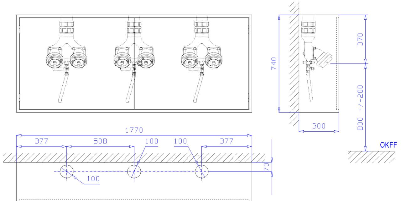
**Aufputzschrank Bauart C, 1260 x 740 x 300 mm (Breite x Höhe x Tiefe)** nach DIN 14461-2 zur Aufnahme von drei Löschwasser-Einspeisearmaturen nach DIN 14461-4. Aus 1 mm Edelstahlblech 1.4301 (V2A) gekantet und verschweißt, frontseitige Stöße verschweißt und verschliffen. Belüftung über Türspalt. Vier Montagebohrungen in der Rückwand. Drei Wasseranschlussöffnungen  $\varnothing$  100 mm im Dach.
