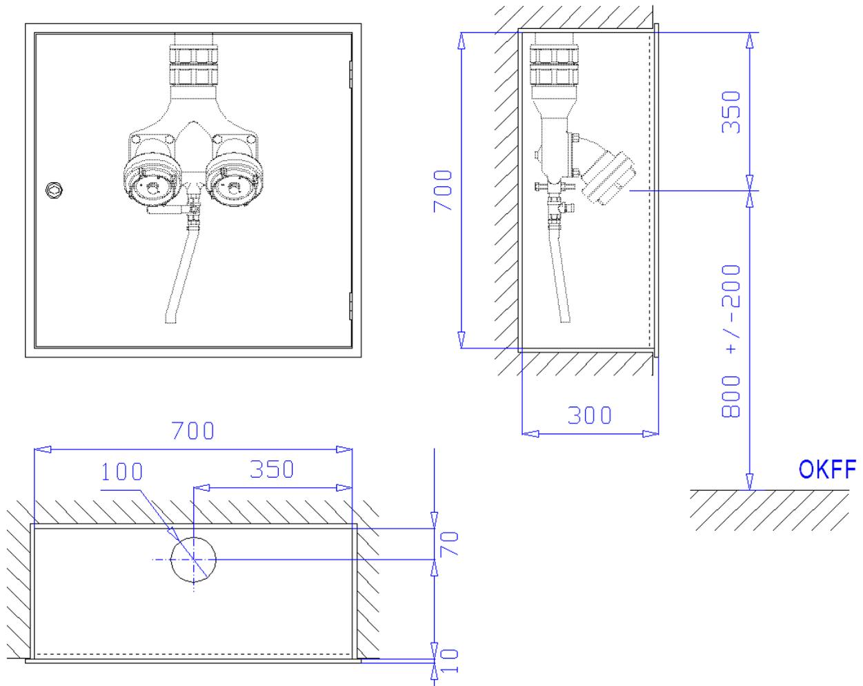
**Unterputzschrank** Bauart B, 700 x 700 x 300 mm, für Nische 720 x 720 x 310 mm (Breite x Höhe x Tiefe) nach DIN 14461-2 zur Aufnahme einer Löschwasser-Einspeisearmatur nach DIN 14461-4. Aus 1 mm Edelstahlblech 1.4301 (V2A) gekantet und verschweißt, Putzleiste 25mm breit gekantet mit 90°-Kantung zur Wand, Umkantungshöhe 10 mm. Belüftung über Türspalt. Vier Montagebohrungen in der Rückwand. Wasseranschluss  $\varnothing$  100 mm im Dach.
