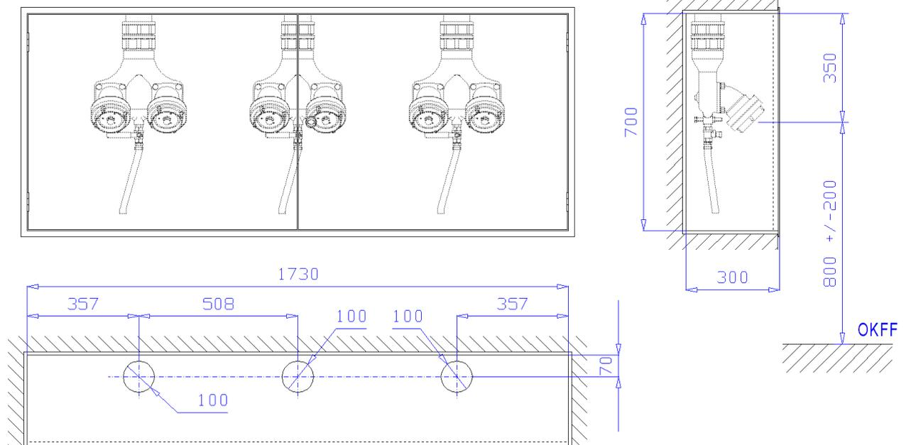
**Unterputzschrank** Bauart B, 1730 x 700 x 300 mm, für Nische 1750 x 720 x 310 mm (Breite x Höhe x Tiefe) nach DIN 14461-2 zur Aufnahme von drei Löschwasser-Einspeisearmaturen nach DIN 14461-4. Aus 1 mm verzinktem Stahlblech gekantet und verschweißt, mit Putzleiste aus Winkleisen 25x25x3 mm, frontseitige Stöße verschweißt und verschliffen. Belüftung über Türspalt. Vier Montagebohrungen in der Rückwand. Drei Wasseranschlussöffnungen  $\varnothing$  100 mm im Dach.
