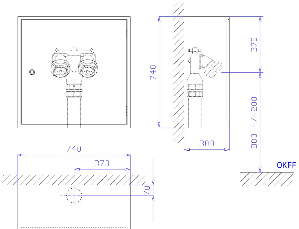
**Aufputzschrank Bauart C, 740 x 740 x 300 mm (Breite x Höhe x Tiefe)** nach DIN 14461-2 zur Aufnahme einer Löschwasser-Einspeisearmatur nach DIN 14461-4. Aus 1 mm verzinktem Stahlblech gekantet und verschweißt, frontseitige Stöße verschweißt und verschliffen. Belüftung über Türspalt. Vier Montagebohrungen in der Rückwand. Wasseranschluss  $\varnothing$  100 mm im Boden.
