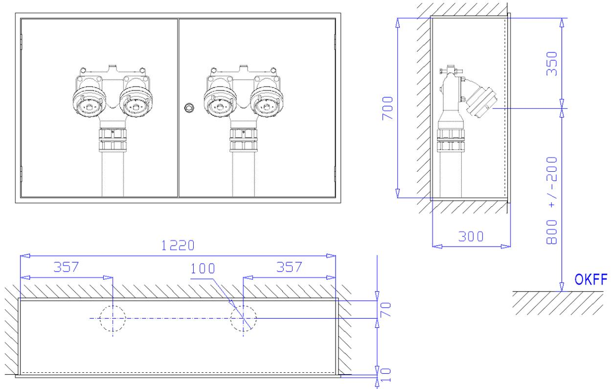
**Unterputzschrank** Bauart B, 1220 x 700 x 300 mm, für Nische 1240 x 720 x 310 mm (Breite x Höhe x Tiefe) nach DIN 14461-2 zur Aufnahme von zwei Löschwasser-Einspeisearmaturen nach DIN 14461-4. Aus 1 mm Edelstahlblech 1.4301 (V2A) gekantet und verschweißt, Putzleiste 25mm breit gekantet mit 90°-Kantung zur Wand, Umkantungshöhe 10 mm. Belüftung über Türspalt. Vier Montagebohrungen in der Rückwand. Zwei Wasseranschlussöffnungen  $\varnothing$  100 mm im Boden.
