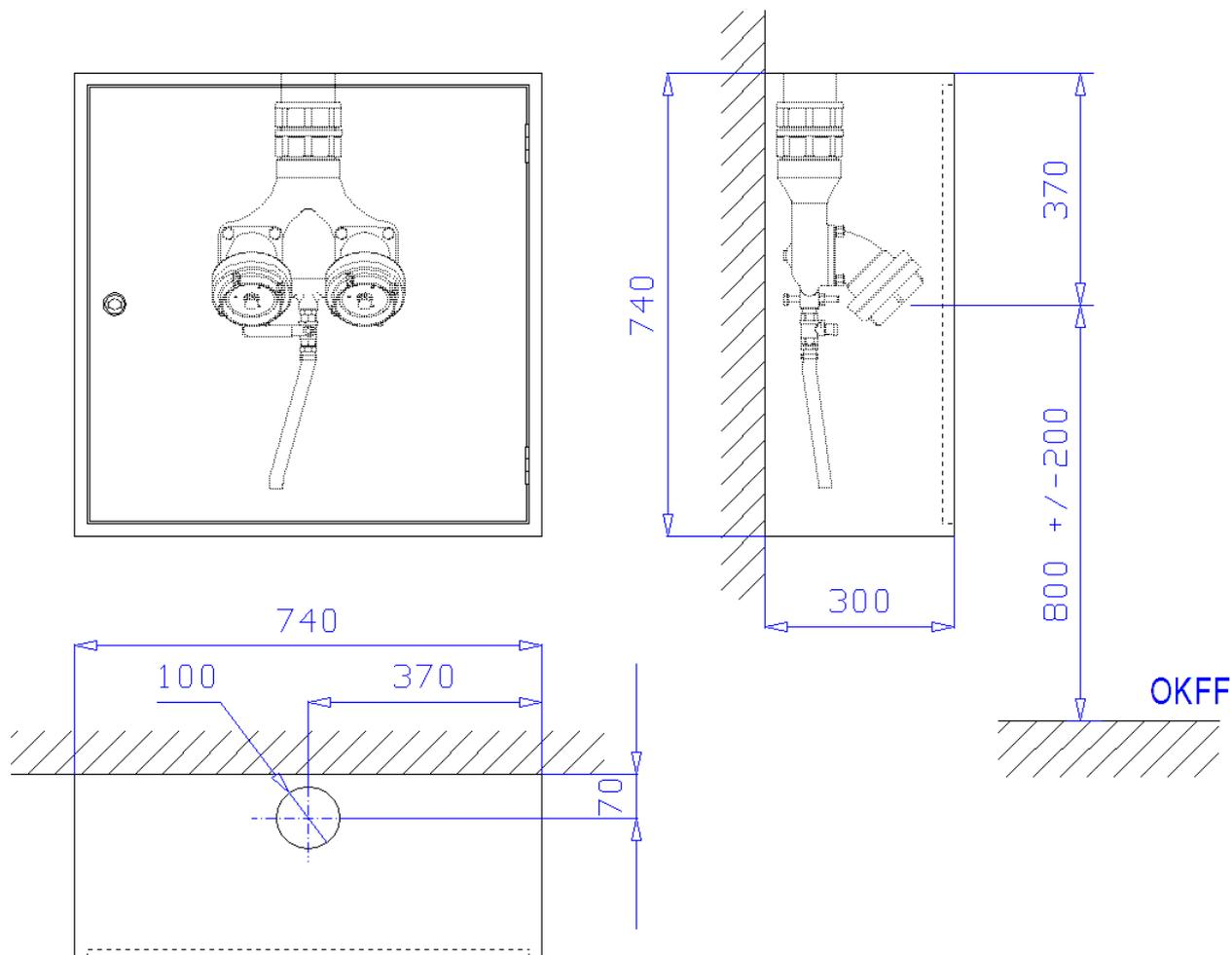
**Aufputzschrank Bauart C, 740 x 740 x 300 mm (Breite x Höhe x Tiefe)** nach DIN 14461-2 zur Aufnahme einer Löschwasser-Einspeisearmatur nach DIN 14461-4. Aus 1 mm Edelstahlblech 1.4301 (V2A) gekantet und verschweißt, frontseitige Stöße verschweißt und verschliffen. Belüftung über Türspalt. Vier Montagebohrungen in der Rückwand. Wasseranschluss  $\varnothing$  100 mm im Dach.
