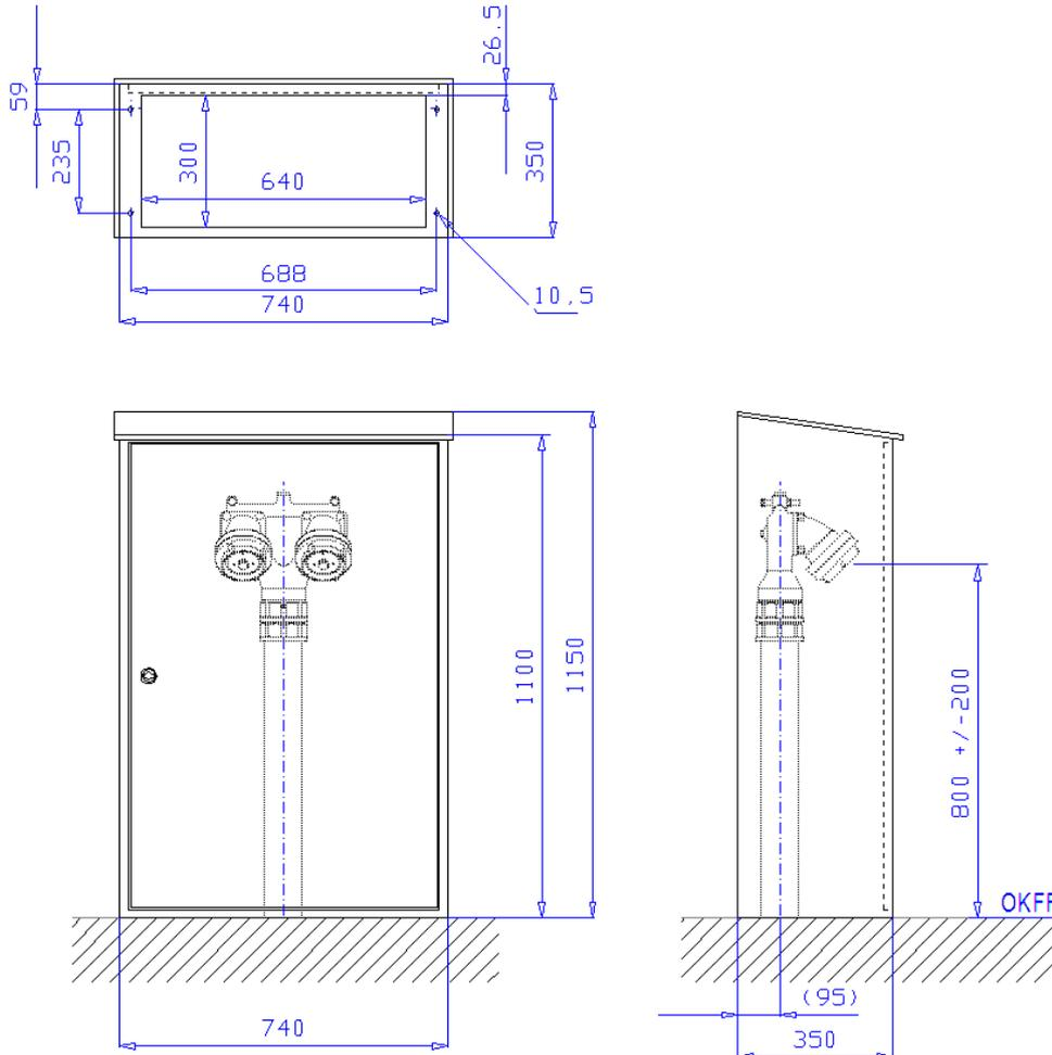
**Schrank zur freien Aufstellung**, 740 x 1100/1150 x 350 mm (Breite x Höhe x Tiefe) nach DIN 14461-2 zur Aufnahme von einer Löschwasser-Einspeisearmatur nach DIN 14461-4. Aus 1 mm Edelstahlblech 1.4301 (V2A) gekantet und verschweißt, frontseitige Stöße verschleißt und verschliffen. Noch vorne abfallendes Wetterschutzdach an drei Seiten überstehen. Belüftung über Türspalt. Boden offen zur Rohreinführung mit umlaufender Umkantung zur Befestigung.
