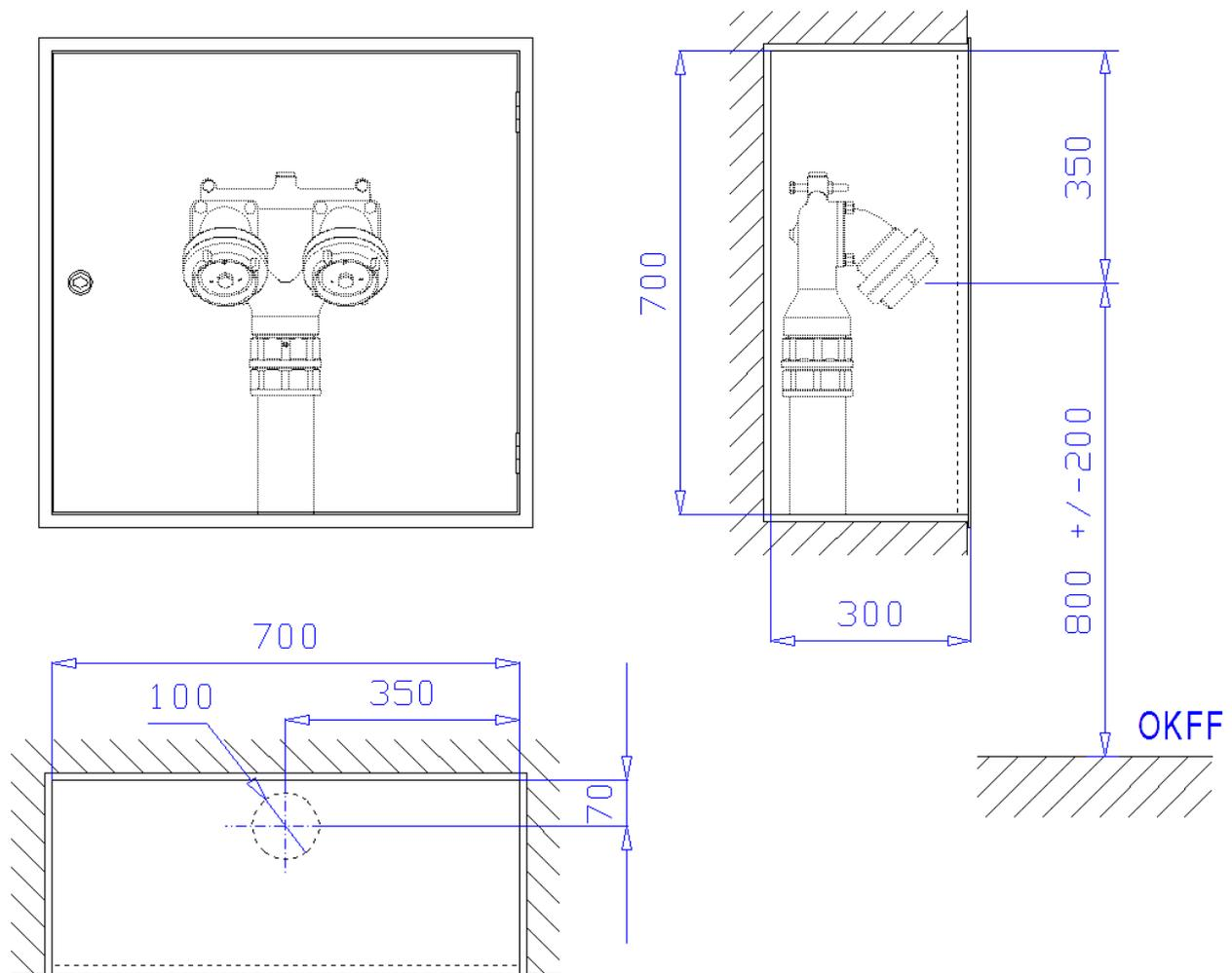
**Unterputzschrank** Bauart B, 700 x 700 x 300 mm, für Nische 720 x 720 x 310 mm (Breite x Höhe x Tiefe) nach DIN 14461-2 zur Aufnahme einer Löschwasser-Einspeisearmatur nach DIN 14461-4. Aus 1 mm verzinktem Stahlblech gekantet und verschweißt, mit Putzleiste aus Winkleisen 25x25x3 mm, frontseitige Stöße verschweißt und verschliffen. Belüftung über Türspalt. Vier Montagebohrungen in der Rückwand. Wasseranschluss  $\varnothing$  100 mm im Boden.
