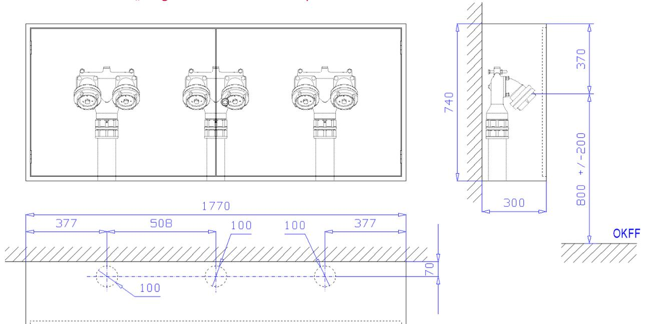
**Aufputzschrank Bauart C, 1260 x 740 x 300 mm (Breite x Höhe x Tiefe)** nach DIN 14461-2 zur Aufnahme von drei Löschwasser-Einspeisearmaturen nach DIN 14461-4. Aus 1 mm Edelstahlblech 1.4301 (V2A) gekantet und verschweißt, frontseitige Stöße verschweißt und verschliffen. Belüftung über Türspalt. Vier Montagebohrungen in der Rückwand. Drei Wasseranschlussöffnungen  $\varnothing$  100 mm im Boden.
