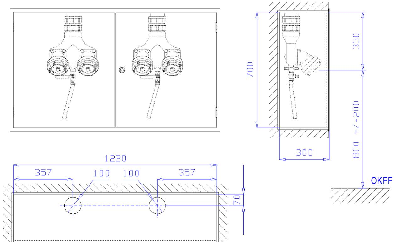
**Unterputzschrank** Bauart B, 1220 x 700 x 300 mm, für Nische 1240 x 720 x 310 mm (Breite x Höhe x Tiefe) nach DIN 14461-2 zur Aufnahme von zwei Löschwasser-Einspeisearmaturen nach DIN 14461-4. Aus 1 mm verzinktem Stahlblech gekantet und verschweißt, mit Putzleiste aus Winkleisen 25x25x3 mm, frontseitige Stöße verschweißt und verschliffen. Belüftung über Türspalt. Vier Montagebohrungen in der Rückwand. Zwei Wasseranschlussöffnungen  $\varnothing$  100 mm im Dach.
