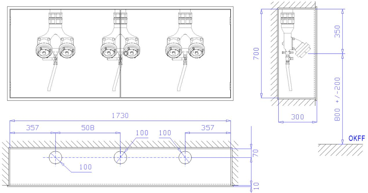
**Unterputzschrank** Bauart B, 1730 x 700 x 300 mm, für Nische 1750 x 720 x 310 mm (Breite x Höhe x Tiefe) nach DIN 14461-2 zur Aufnahme von drei Löschwasser-Einspeisearmaturen nach DIN 14461-4. Aus 1 mm Edelstahlblech 1.4301 (V2A) gekantet und verschweißt, Putzleiste 25mm breit gekantet mit 90°-Kantung zur Wand, Umkantungshöhe 10 mm. Belüftung über Türspalt. Vier Montagebohrungen in der Rückwand. Drei Wasseranschlussöffnungen  $\varnothing$  100 mm im Dach.
