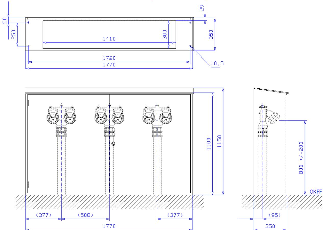
**Schrank zur freien Aufstellung**, 1770 x 1100/1150 x 350 mm (Breite x Höhe x Tiefe) nach DIN 14461-2 zur Aufnahme von drei Löschwasser-Einspeisearmaturen nach DIN 14461-4. Aus 1 mm verzinktem Stahlblech gekantet und verschweißt, frontseitige Stöße verschweißt und verschliffen. Noch vorne abfallendes Wetterschutzdach an drei Seiten überstehen. Belüftung über Türspalt. Boden offen zur Rohreinführung mit umlaufender Umkantung zur Befestigung.
