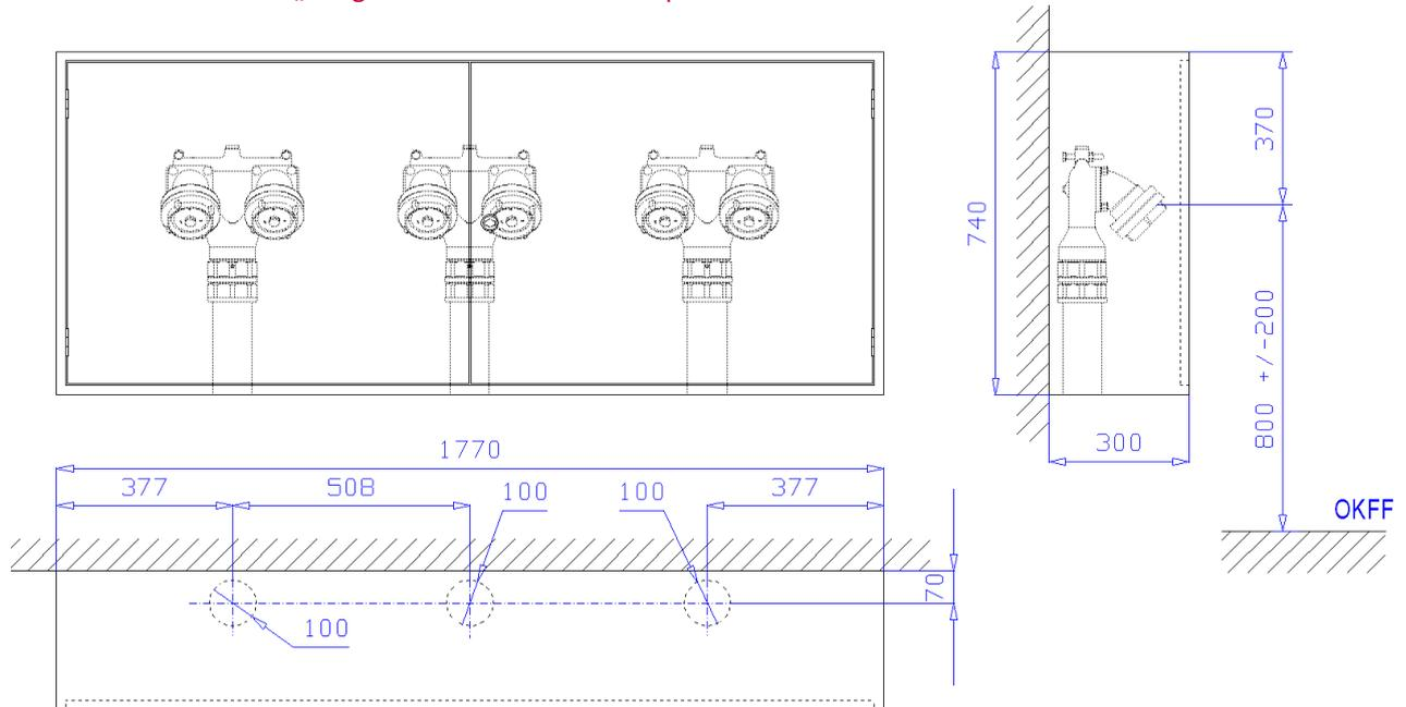
**Aufputzschrank Bauart C, 1260 x 740 x 300 mm (Breite x Höhe x Tiefe)** nach DIN 14461-2 zur Aufnahme von drei Löschwasser-Einspeisearmaturen nach DIN 14461-4. Aus 1 mm verzinktem Stahlblech gekantet und verschweißt, frontseitige Stöße verschweißt und verschliffen. Belüftung über Türspalt. Vier Montagebohrungen in der Rückwand. Drei Wasseranschlussöffnungen  $\varnothing$  100 mm im Boden.
