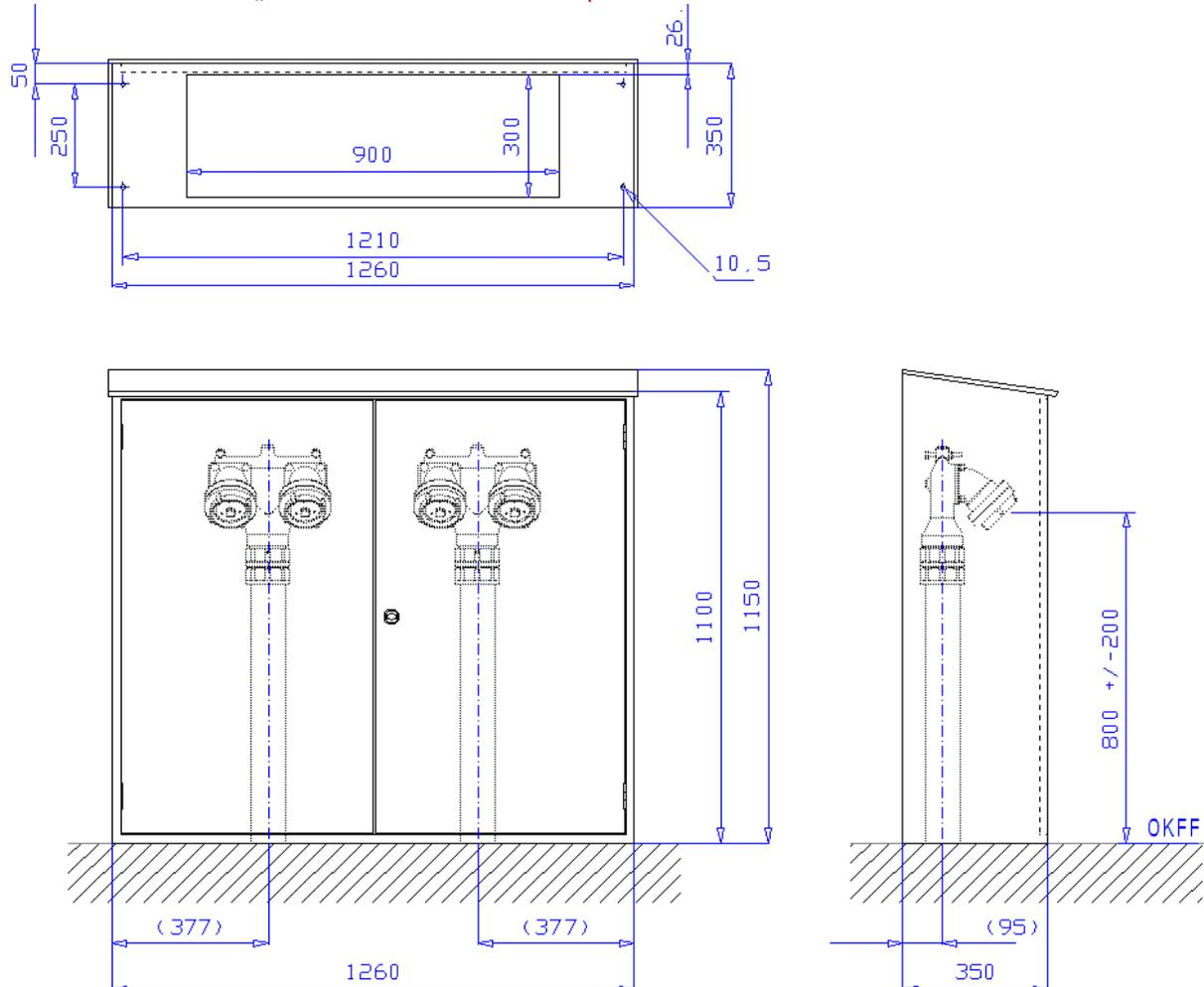
**Schrank zur freien Aufstellung**, 1260 x 1100/1150 x 350 mm (Breite x Höhe x Tiefe) nach DIN 14461-2 zur Aufnahme von zwei Löschwasser-Einspeisearmaturen nach DIN 14461-4. Aus 1 mm Edelstahlblech 1.4301 (V2A) gekantet und verschweißt, frontseitige Stöße verschweißt und verschliffen. Noch vorne abfallendes Wetterschutzdach an drei Seiten überstehen. Belüftung über Türspalt. Boden offen zur Rohreinführung mit umlaufender Umkantung zur Befestigung.
