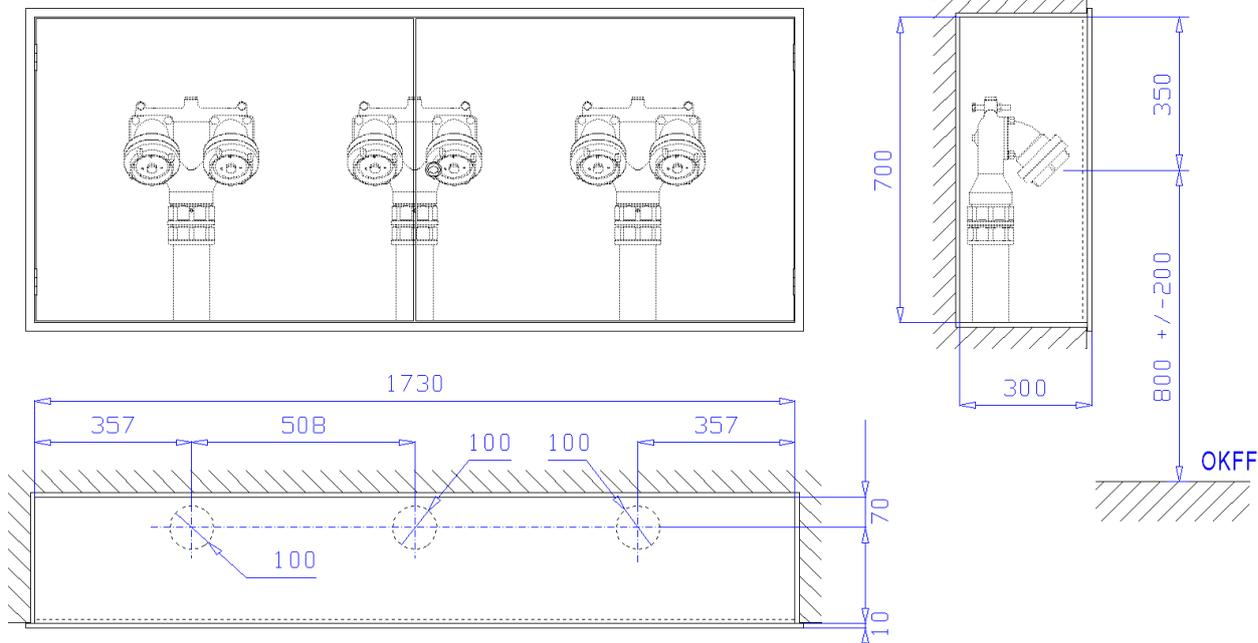
**Unterputzschrank** Bauart B, 1730 x 700 x 300 mm, für Nische 1750 x 720 x 310 mm (Breite x Höhe x Tiefe) nach DIN 14461-2 zur Aufnahme von drei Löschwasser-Einspeisearmaturen nach DIN 14461-4. Aus 1 mm Edelstahlblech 1.4301 (V2A) gekantet und verschweißt, Putzleiste 25mm breit gekantet mit 90°-Kantung zur Wand, Umkantungshöhe 10 mm. Belüftung über Türspalt. Vier Montagebohrungen in der Rückwand. Drei Wasseranschlussöffnungen  $\varnothing$  100 mm im Boden.
