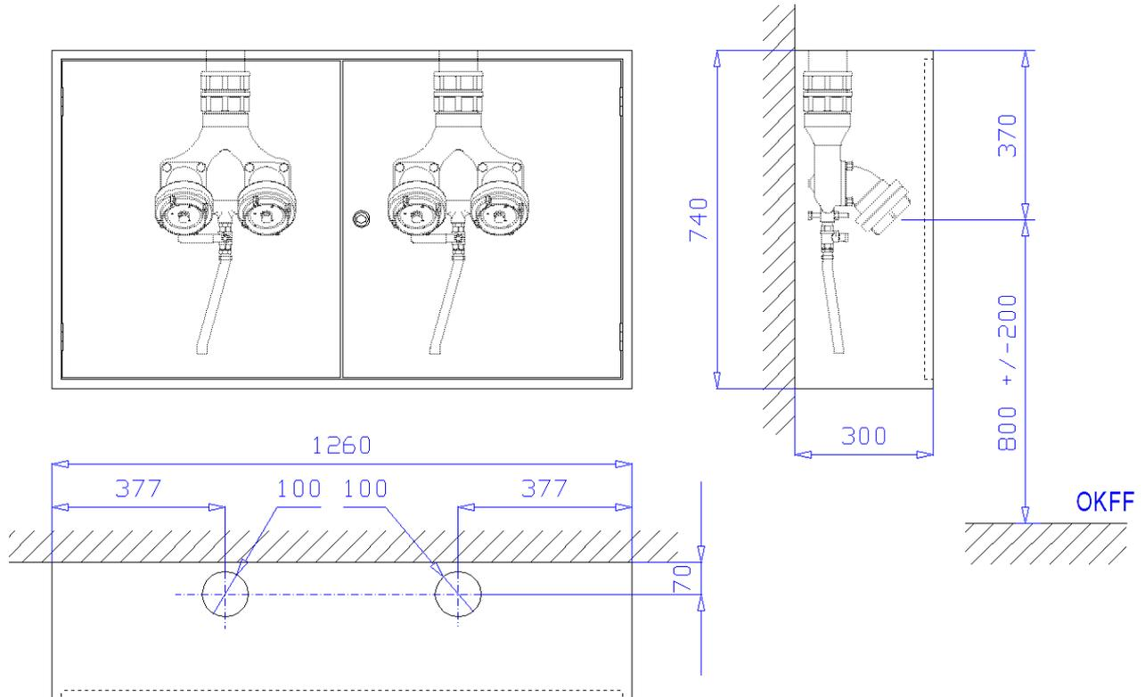
**Aufputzschrank** Bauart C, 1260 x 740 x 300 mm (Breite x Höhe x Tiefe) nach DIN 14461-2 zur Aufnahme von zwei Löschwasser-Einspeisearmaturen nach DIN 14461-4. Aus 1 mm verzinktem Stahlblech gekantet und verschweißt, frontseitige Stöße verschweißt und verschliffen. Belüftung über Türspalt. Vier Montagebohrungen in der Rückwand. Zwei Wasseranschlussöffnungen  $\varnothing$  100 mm im Dach.
