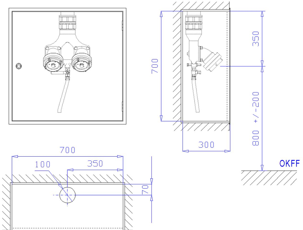
**Unterputzschrank** Bauart B, 700 x 700 x 300 mm, für Nische 720 x 720 x 310 mm (Breite x Höhe x Tiefe) nach DIN 14461-2 zur Aufnahme einer Löschwasser-Einspeisearmatur nach DIN 14461-4. Aus 1 mm verzinktem Stahlblech gekantet und verschweißt, mit Putzleiste aus Winkleisen 25x25x3 mm, frontseitige Stöße verschweißt und verschliffen. Belüftung über Türspalt. Vier Montagebohrungen in der Rückwand. Wasseranschluss  $\varnothing$  100 mm im Dach.
