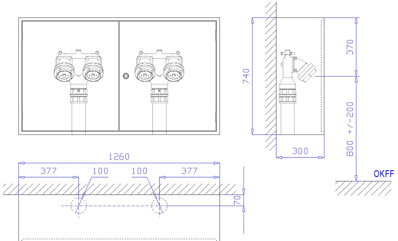
**Aufputzschrank Bauart C, 1260 x 740 x 300 mm** (Breite x Höhe x Tiefe) nach DIN 14461-2 zur Aufnahme von zwei Löschwasser-Einspeisearmaturen nach DIN 14461-4. Aus 1 mm verzinktem Stahlblech gekantet und verschweißt, frontseitige Stöße verschweißt und verschliffen. Belüftung über Türspalt. Vier Montagebohrungen in der Rückwand. Zwei Wasseranschlussöffnungen  $\varnothing$  100 mm im Boden.
