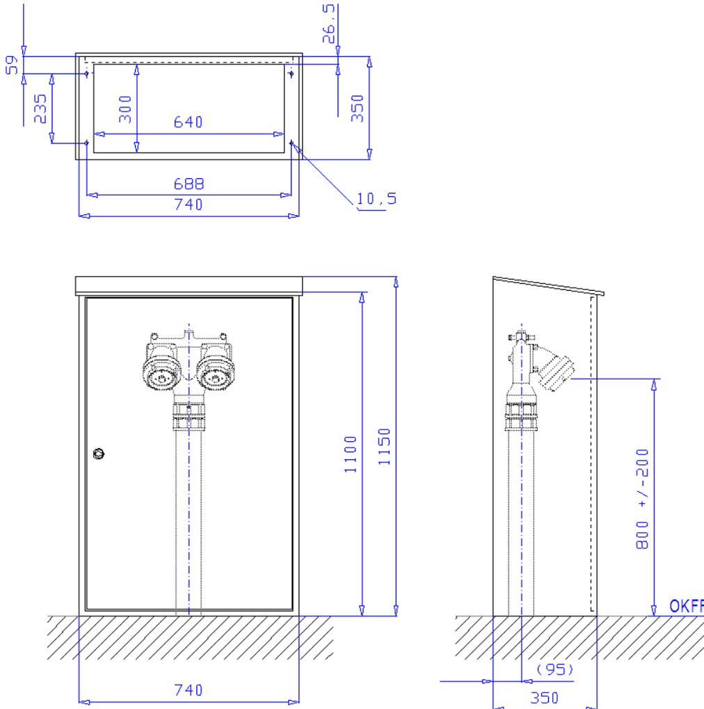
**Schrank zur freien Aufstellung**, 740 x 1100/1150 x 350 mm (Breite x Höhe x Tiefe) nach DIN 14461-2 zur Aufnahme von einer Löschwasser-Einspeisearmatur nach DIN 14461-4. Aus 1 mm verzinktem Stahlblech gekantet und verschweißt, frontseitige Stöße verschweißt und verschliffen. Noch vorne abfallendes Wetterschutzdach an drei Seiten überstehen. Belüftung über Türspalt. Boden offen zur Rohreinführung mit umlaufender Umkantung zur Befestigung.
