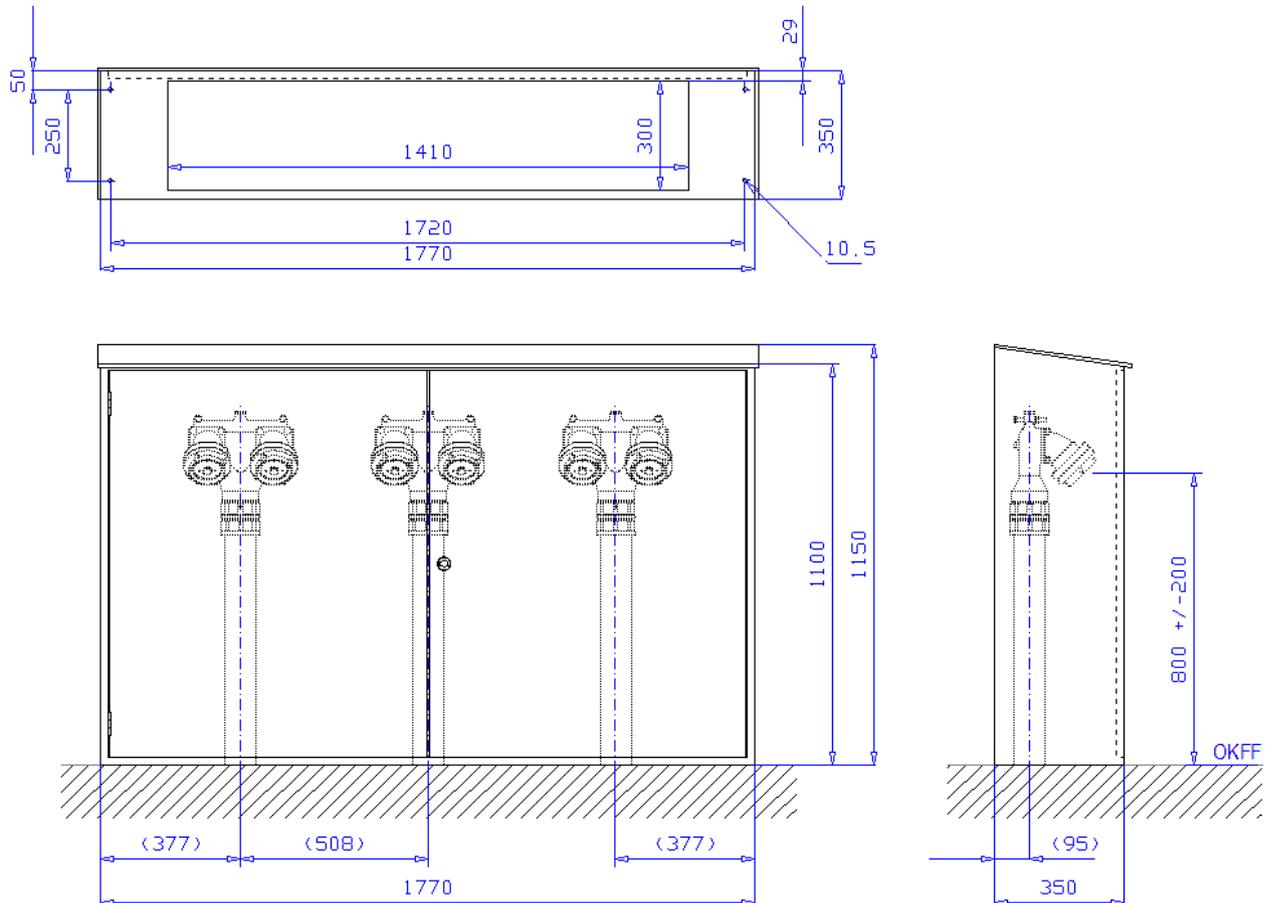
**Schrank zur freien Aufstellung, 1770 x 1100/1150 x 350 mm (Breite x Höhe x Tiefe)** nach DIN 14461-2 zur Aufnahme von drei Löschwasser-Einspeisearmaturen nach DIN 14461-4. Aus 1 mm Edelstahlblech 1.4301 (V2A) gekantet und verschweißt, frontseitige Stöße verschweißt und verschliffen. Noch vorne abfallendes Wetterschutzdach an drei Seiten überstehen. Belüftung über Türspalt. Boden offen zur Rohreinführung mit umlaufender Umkantung zur Befestigung.
