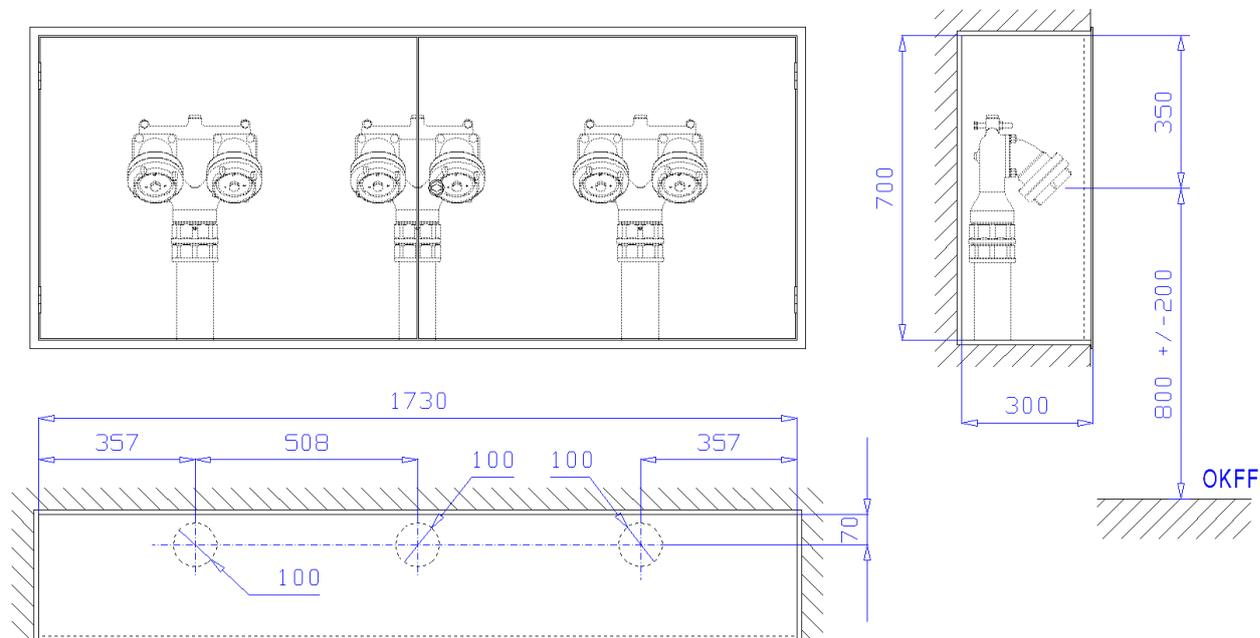
**Unterputzschrank** Bauart B, 1730 x 700 x 300 mm, für Nische 1750 x 720 x 310 mm (Breite x Höhe x Tiefe) nach DIN 14461-2 zur Aufnahme von drei Löschwasser-Einspeisearmaturen nach DIN 14461-4. Aus 1 mm verzinktem Stahlblech gekantet und verschweißt, mit Putzleiste aus Winkleisen 25x25x3 mm, frontseitige Stöße verschweißt und verschliffen. Belüftung über Türspalt. Vier Montagebohrungen in der Rückwand. Drei Wasseranschlussöffnungen  $\varnothing$  100 mm im Boden.
