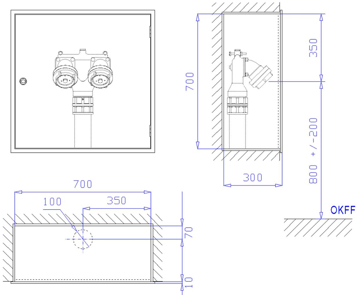
**Unterputzschrank** Bauart B, 700 x 700 x 300 mm, für Nische 720 x 720 x 310 mm (Breite x Höhe x Tiefe) nach DIN 14461-2 zur Aufnahme einer Löschwasser-Einspeisearmatur nach DIN 14461-4. Aus 1 mm Edelstahlblech 1.4301 (V2A) gekantet und verschweißt, Putzleiste 25mm breit gekantet mit 90°-Kantung zur Wand, Umkantungshöhe 10 mm. Belüftung über Türspalt. Vier Montagebohrungen in der Rückwand. Wasseranschluss  $\varnothing$  100 mm im Boden.
