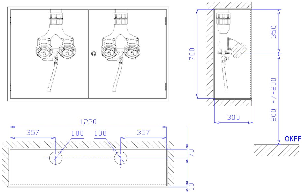
**Unterputzschrank Bauart B, 1220 x 700 x 300 mm**, für Nische 1240 x 720 x 310 mm (Breite x Höhe x Tiefe) nach DIN 14461-2 zur Aufnahme von zwei Löschwasser-Einspeisearmaturen nach DIN 14461-4. Aus 1 mm Edelstahlblech 1.4301 (V2A) gekantet und verschweißt, Putzleiste 25mm breit gekantet mit 90°-Kantung zur Wand, Umkantungshöhe 10 mm. Belüftung über Türspalt. Vier Montagebohrungen in der Rückwand. Zwei Wasseranschlussöffnungen  $\varnothing$  100 mm im Dach.
